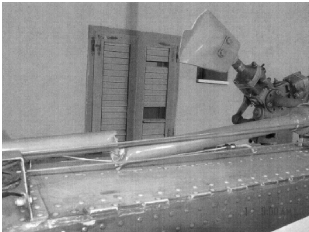
Albero di trasmissione moto al rotore di coda.
