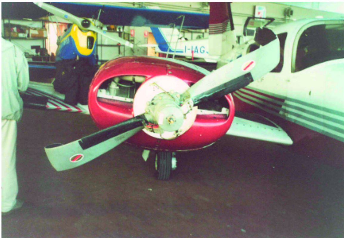
Danni elica motore destro.
