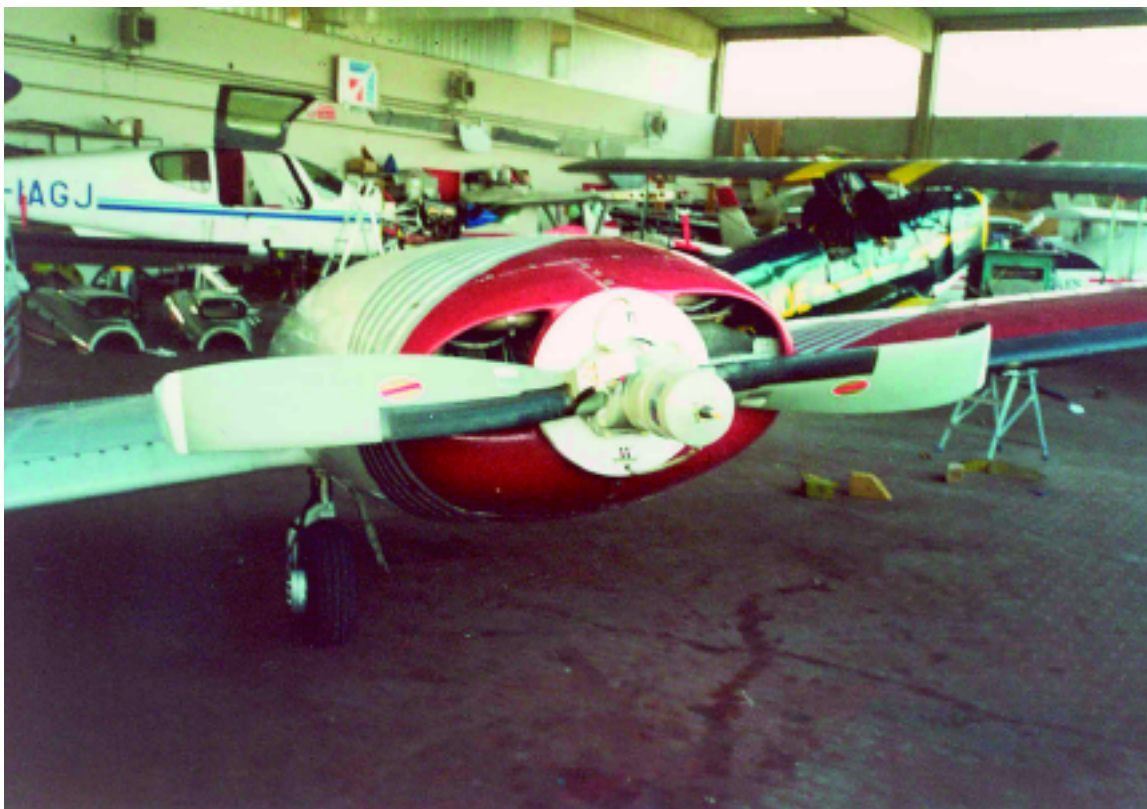
Danni elica motore sinistro.
