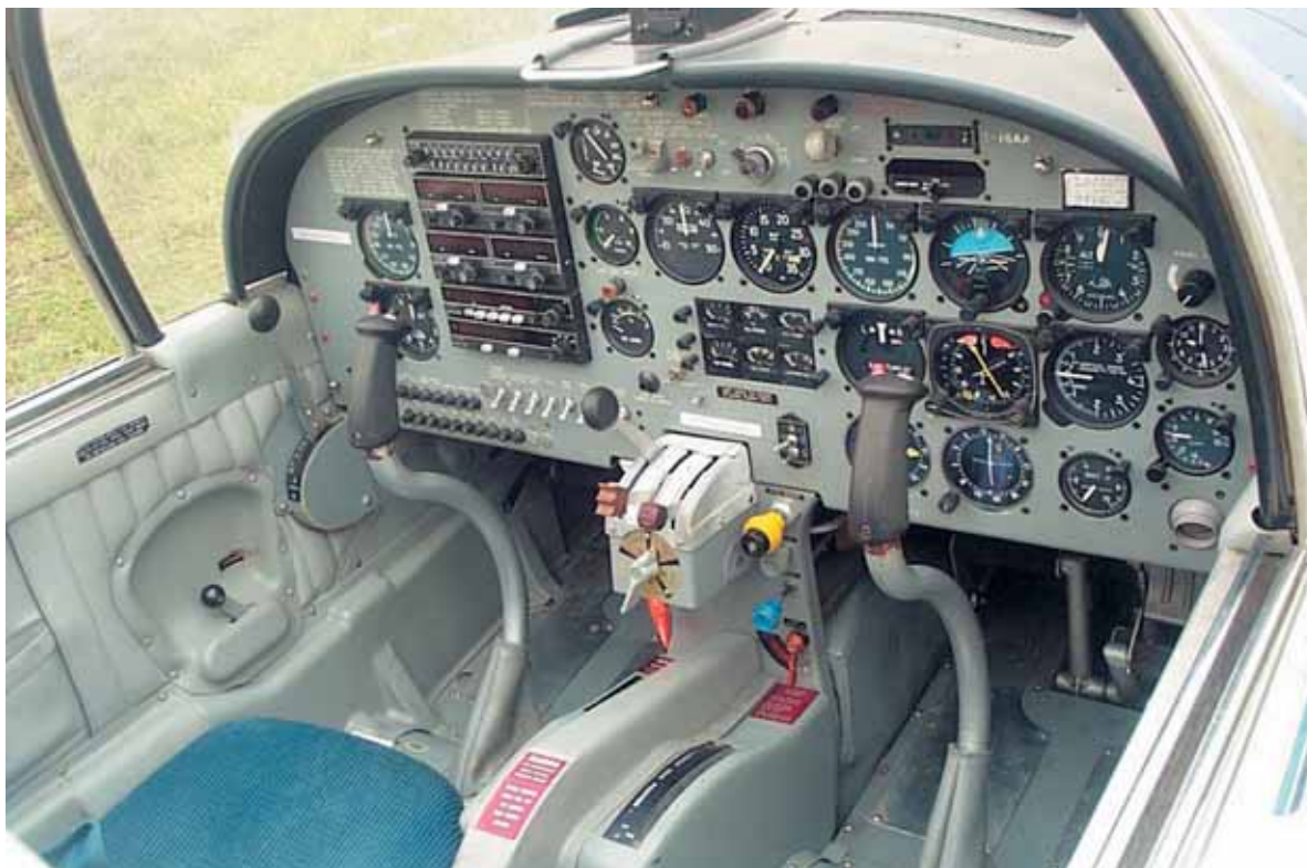
Strumentazione e comandi di volo. Notare la posizione della manetta motore e quella della leva passo elica.
