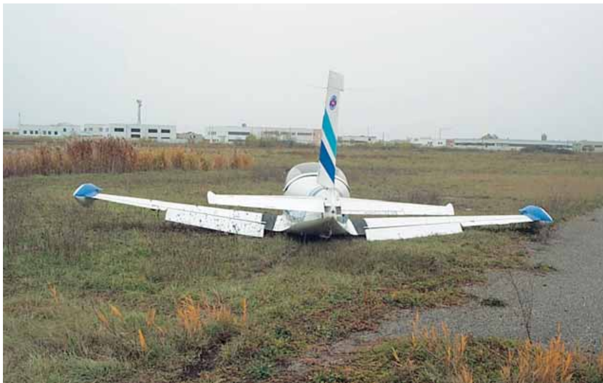
Vista posteriore aeromobile. Notare i flap in posizione estratta.
