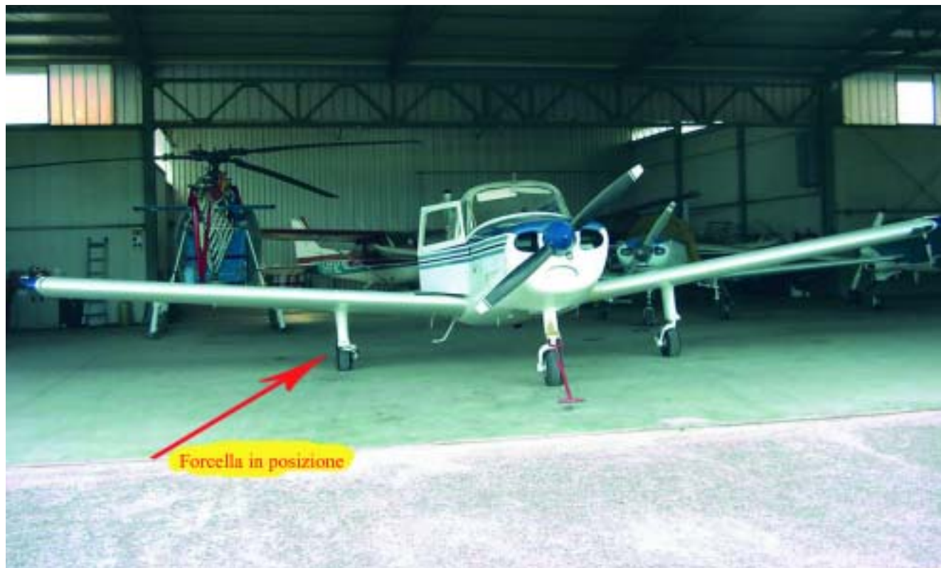
Carrello destro riposizionato dopo l'incidente.
