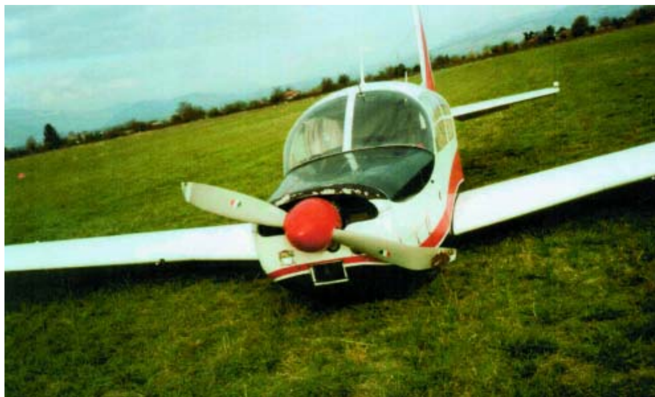
L'aeromobile dopo l'evento: si possono notare i danni riportati dall'elica.
