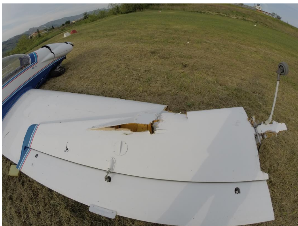
Foto 2: primo piano dei danni riportati dalla semiala destra del D-KIMP.
