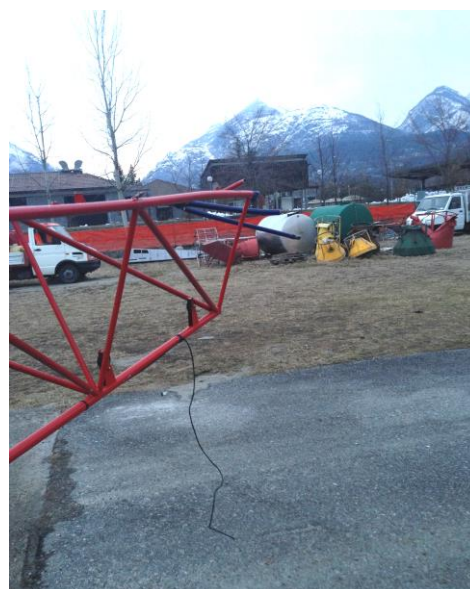
Foto 3: danneggiamento della trave di coda.
