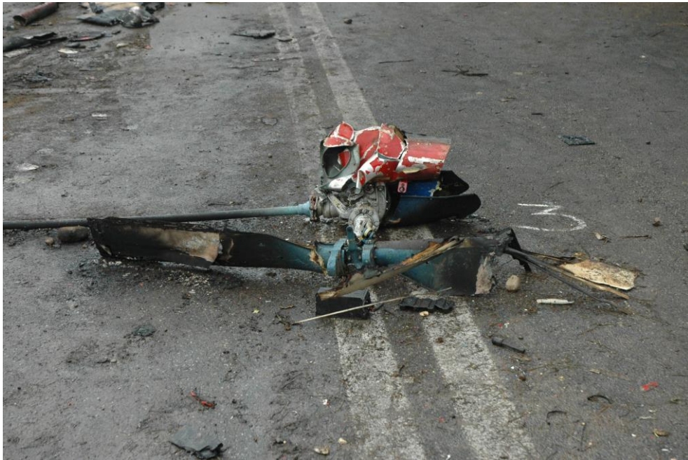
Foto 5: scatola a 90° e rotore di coda.
