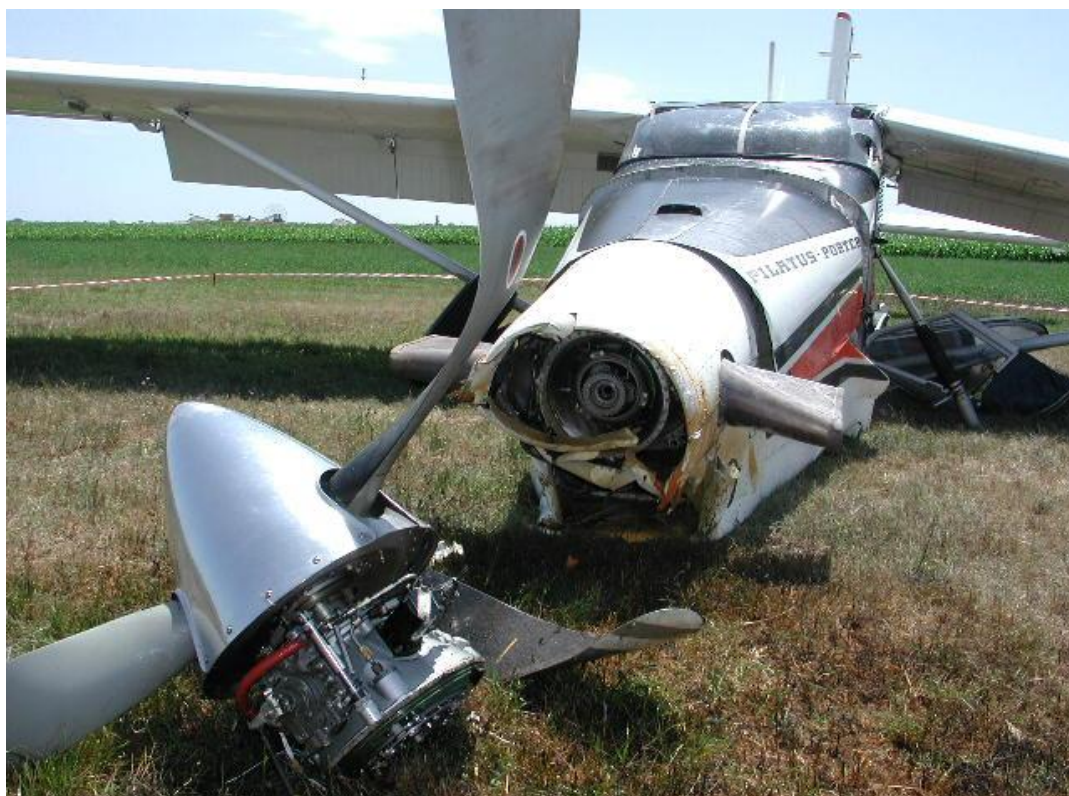
Foto 3: il complessivo dell'elica staccato dal motore.
