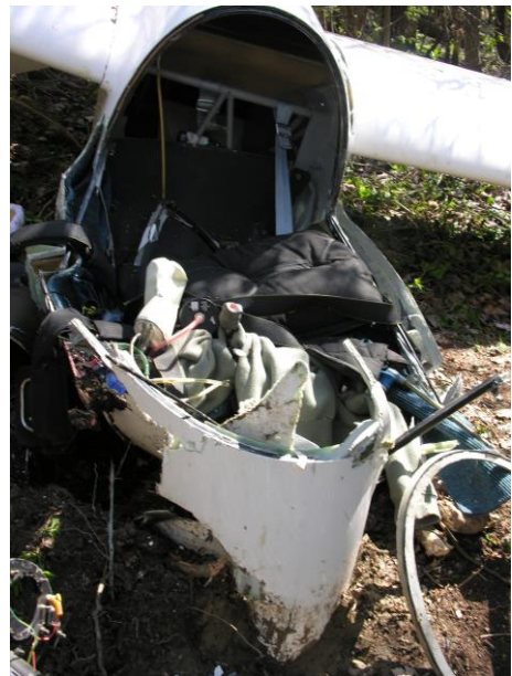
Foto 4 e 5: particolari della penetrazione del musetto dell'aliante nel terreno.
