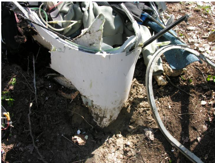
Foto 4 e 5: particolari della penetrazione del musetto dell'aliante nel terreno.
