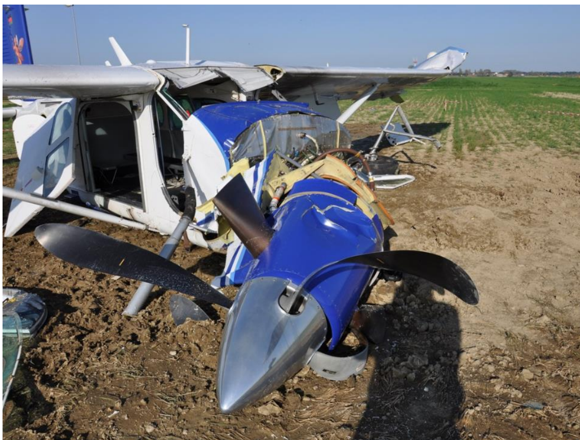
Foto 5: danni a carico del muso dell'aeromobile e del complessivo motore/elica.
