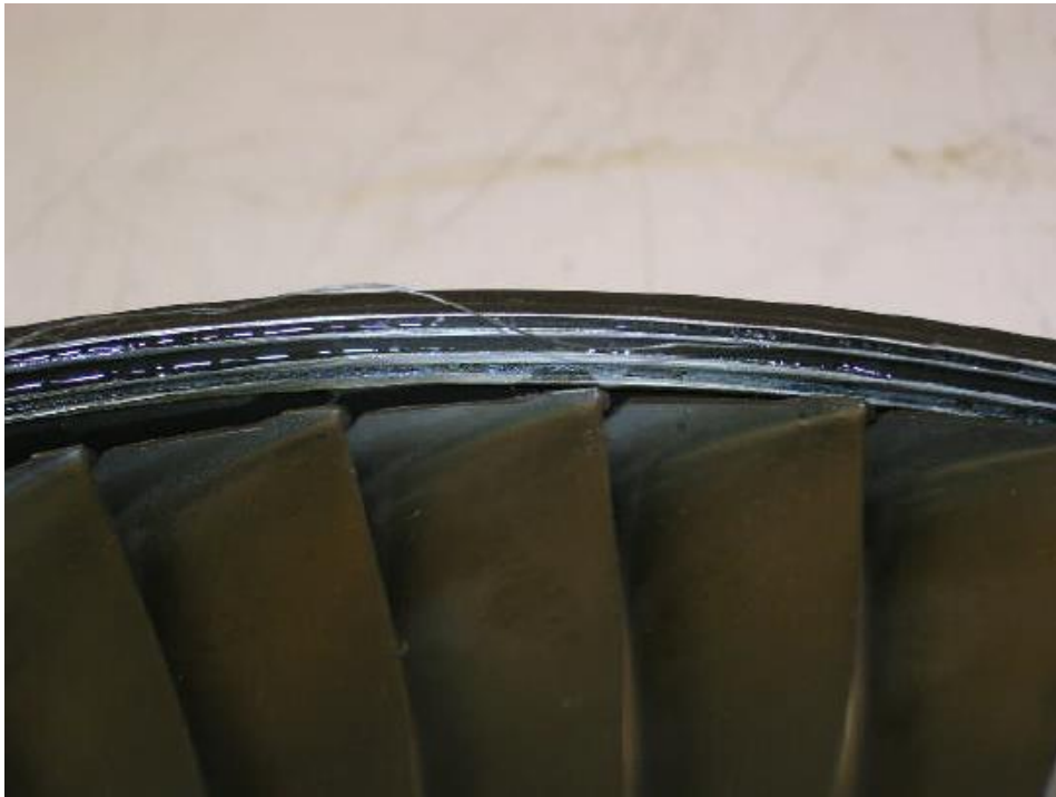
Foto 14: particolare dei segni da sfregamento sulla turbina di potenza.
