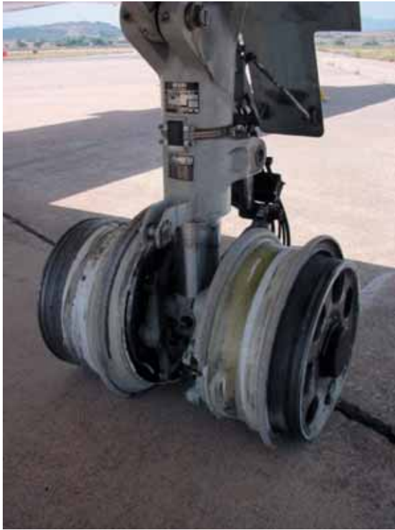
Danni ai cerchioni carrello sinistro.
