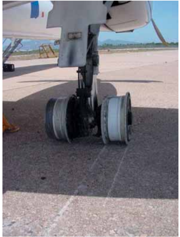
Danni ai cerchioni carrello destro.
