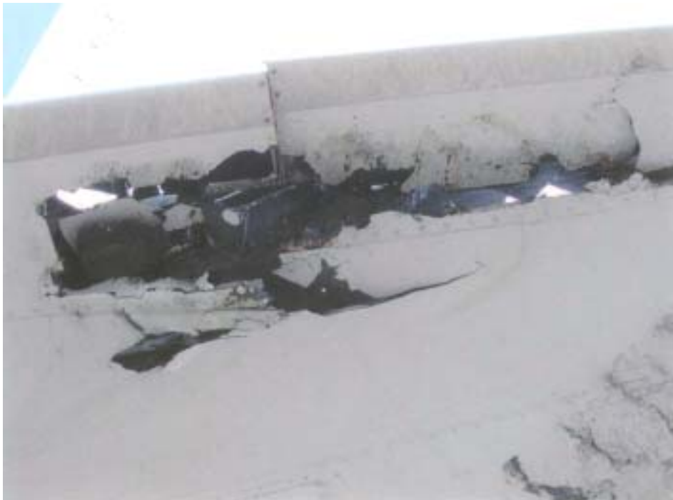
Danni dell'aeromobile; particolare stabilizzatore sinistro
