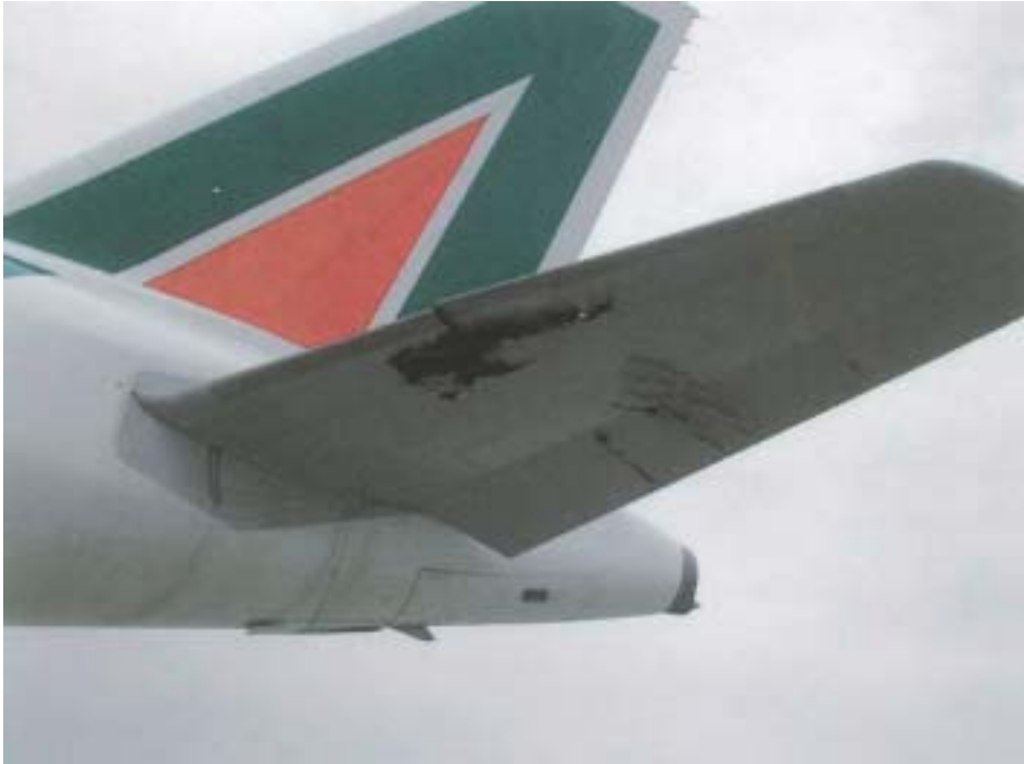
Danni dell'aeromobile; stabilizzatore sinistro
