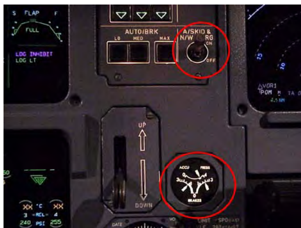
Foto n. 6: strumento triplo e interruttore A/SKID & N/W STRG.
