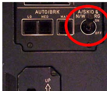
Foto n. 3: interruttore utilizzato per il RESET.
