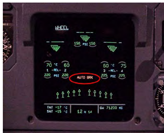
Foto n. 5: avviso avaria sul Lower ECAM.
