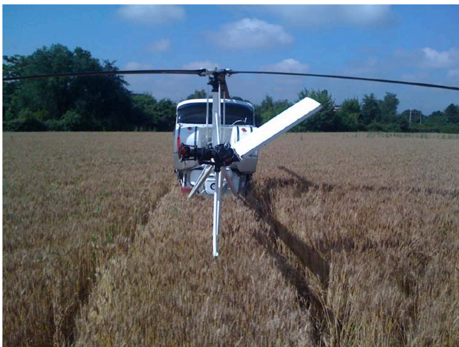
Foto 2: le tracce dei pattini di atterraggio lasciate durante l'atterraggio forzato.
