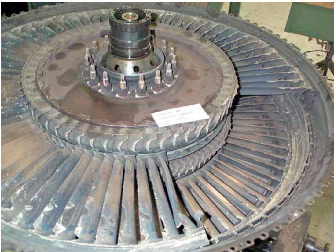
Danni al 3° e 4° stadio rotore turbina di bassa pressione.
