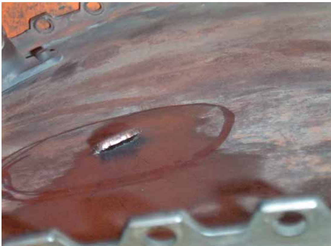
Perforazione casing Low Pressure Turbine all'altezza del 3° stadio rotore.
