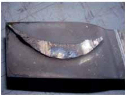
Tipica rottura a fatica (HCF) di una palaletta 4° stadio rotore turbina.
