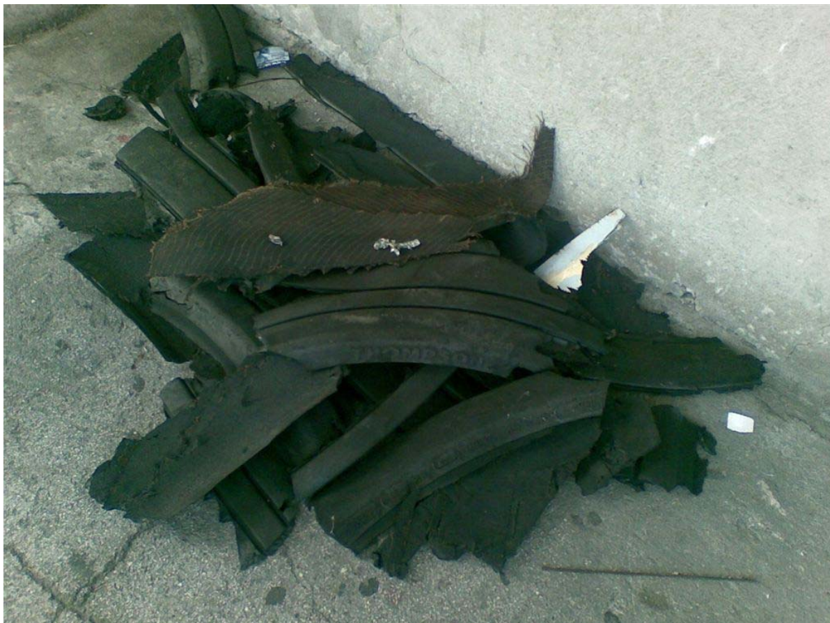
Foto 10: resti del pneumatico I-DACY rinvenuti sulla pista 25.
