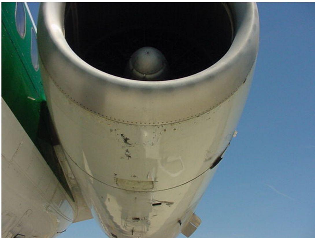
Foto 4: danneggiamenti presa d'aria motore sinistro.
