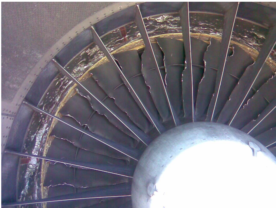
Foto 5: danneggiamenti primo stadio rotorico compressore motore sinistro.
