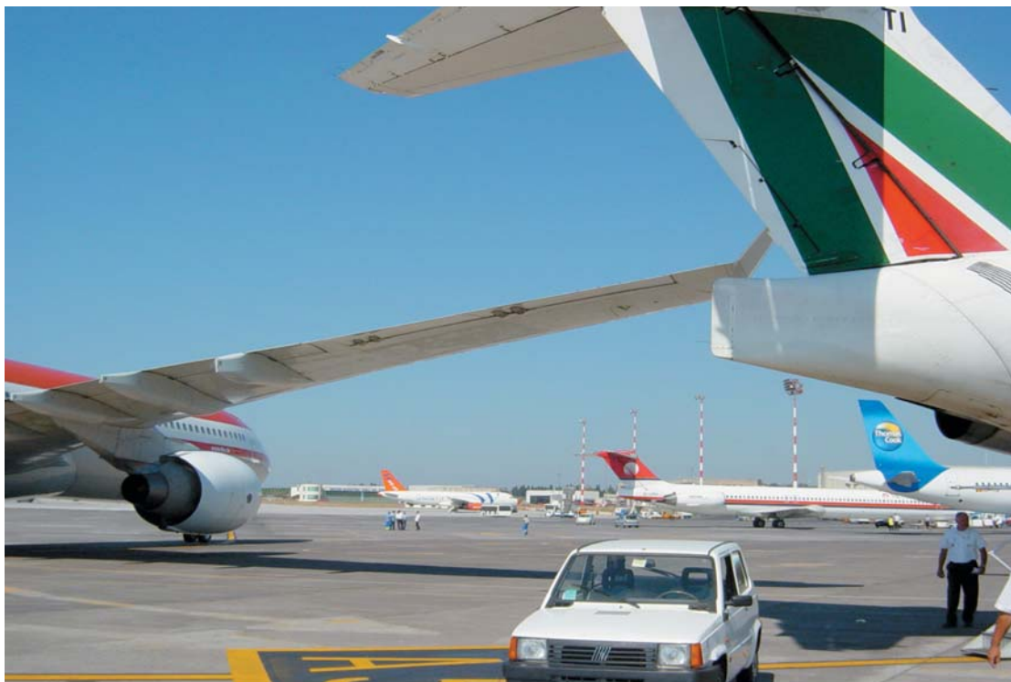
L'aeromobile D-AERF (a sinistra), durante il rullaggio, ha urtato il timone di coda dell'aeromobile I-DATI (a destra).
