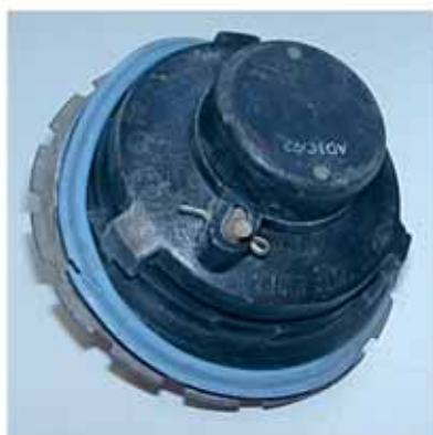
Danneggiamento della guarnizione del Fuel Filler Cap .
