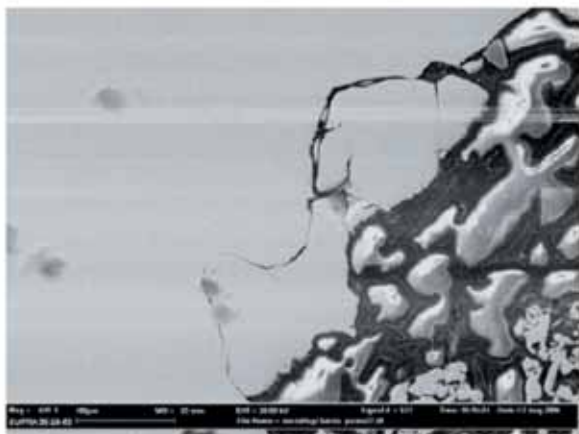
Figura 15– sezione superficie di rottura intergranulare
