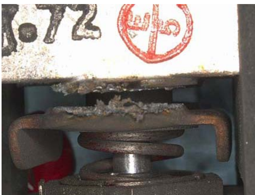
Foto 7: superficie del contatto mobile A1.
