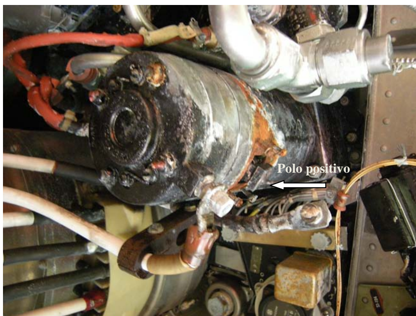
Foto 4: APU starter prima della rimozione.
