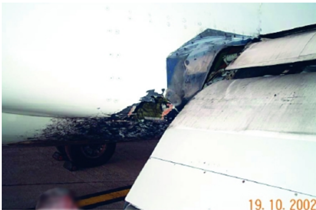
Danni attaccatura semiala-fusoliera. Notare il foro sulla struttura determinato dall'impatto del portellone e dei pezzi di pneumatico staccatisi dal carrello di atterraggio destro.
