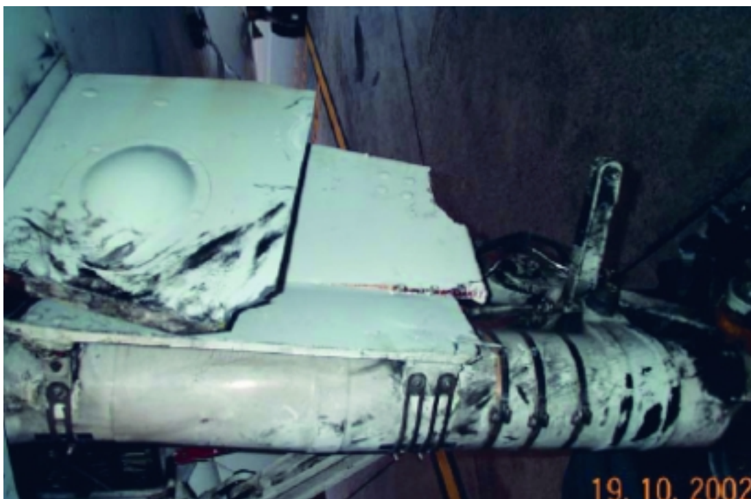
Gamba carrello destro. Notare parte del portellone mancante ed i segni di impatto della gomma del pneumatico con la struttura.
