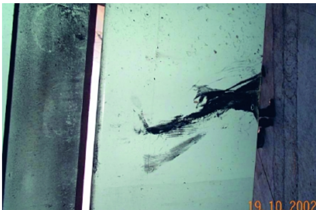
Segni di impatto con il flap della semiala destra.
