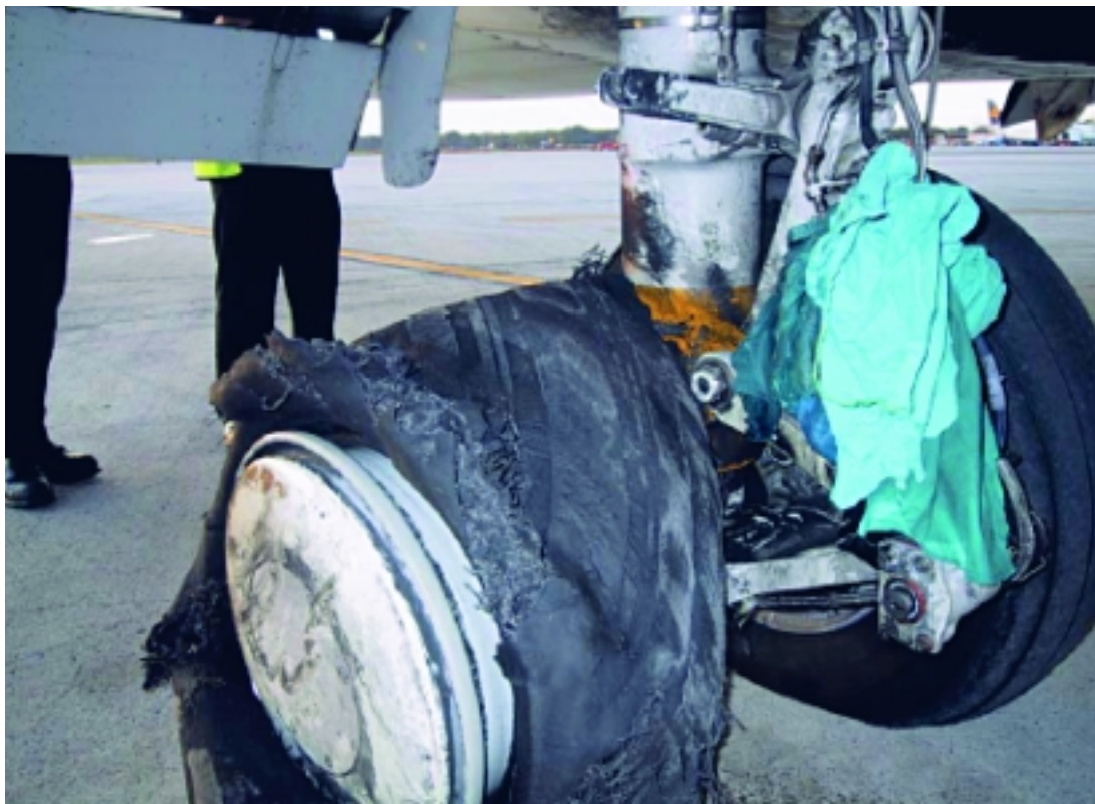
Carrello di atterraggio destro. Notare i danni alla ruota esterna.
