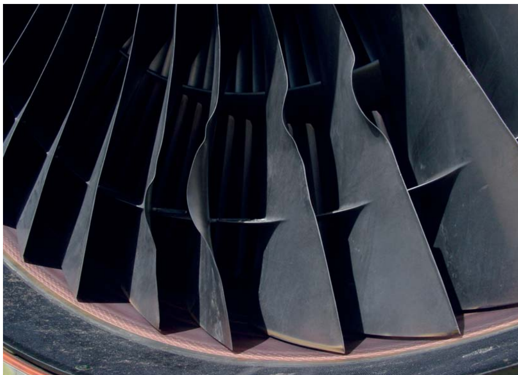
Danneggiamenti palette del fan motore sinistro (dettaglio).
