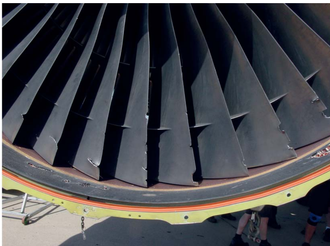
Danneggiamenti palette del fan motore destro (dettaglio).
