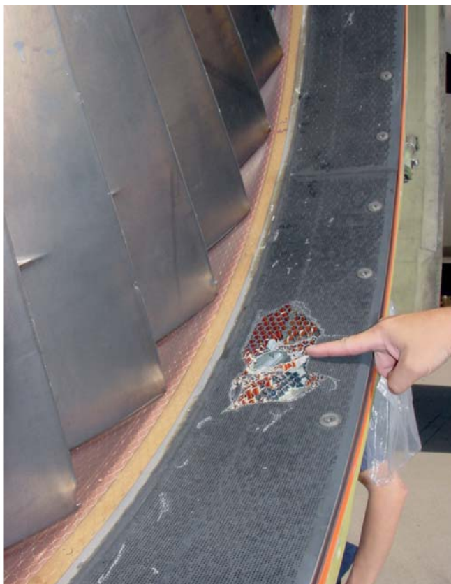
Danneggiamenti superficie interna del condotto del fan motore destro (dettaglio).
