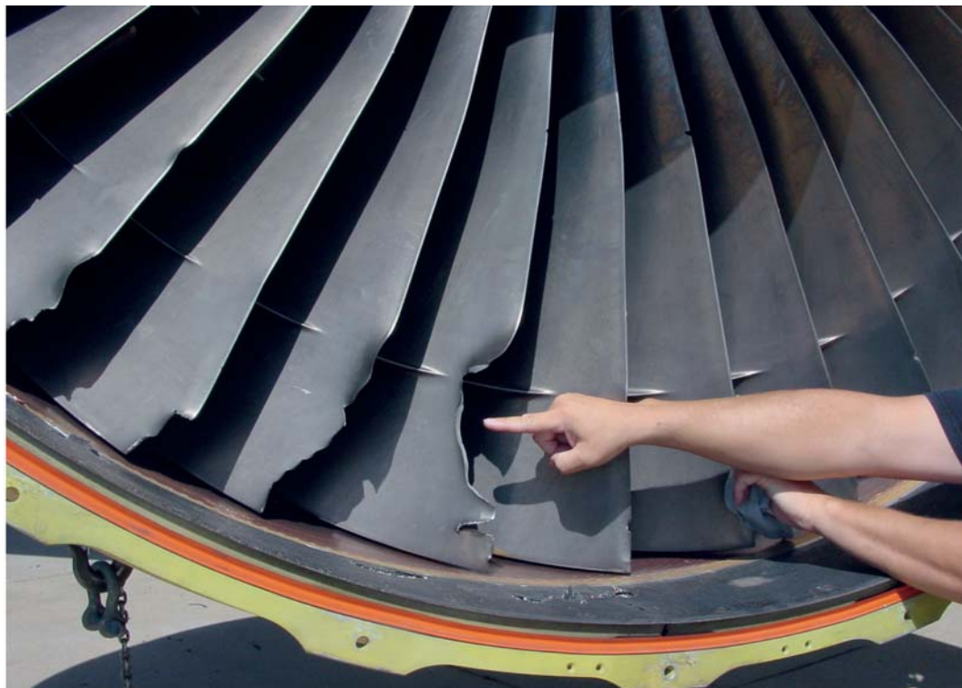
Danneggiamenti palette del fan motore destro (dettaglio).
