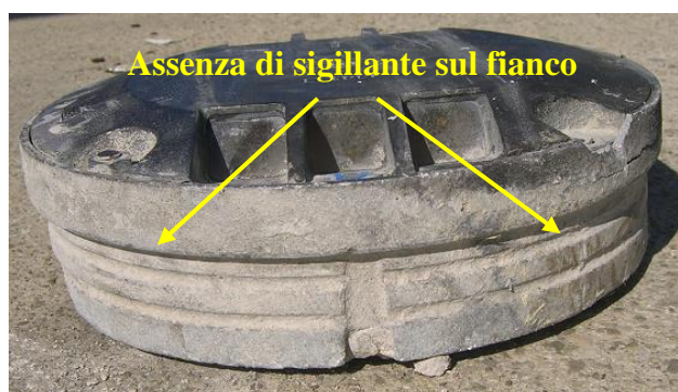
Foto 7: vista laterale della plafoniera n. 43 (gusci superiore e inferiore collegati tramite bulloni).
