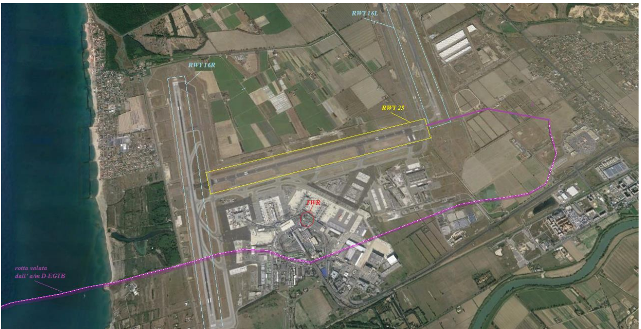
Figura 2: traccia radar della rotta volata dal D-EGTB in fase di atterraggio per RWY 25.
