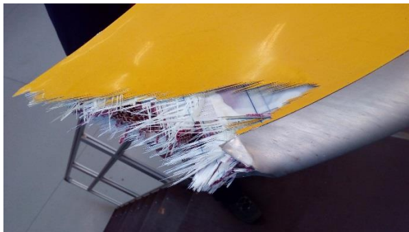
Foto 3: primo piano del danneggiamento di una delle pale del rotore principale.
