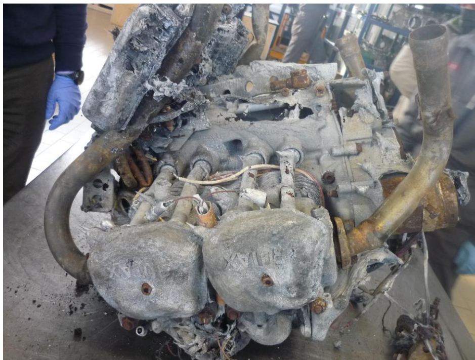
Foto 21: il motore, separato dal relitto, in procinto di essere smontato per gli accertamenti.
