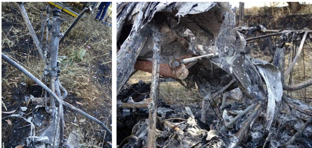
Foto 19 e 20: particolare dell'attuatore e dei leverismi dell'impianto flap.
