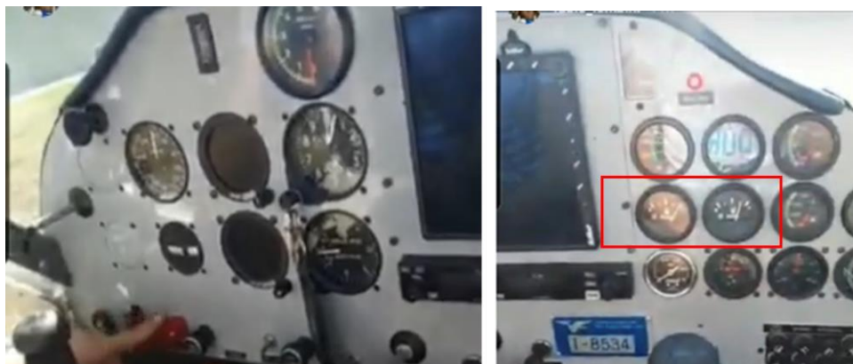
Foto 31 e 32: fermo immagine tratto dal video caricato dal passeggero su social network , indicante il quantitativo di carburante imbarcato prima della messa in moto.
