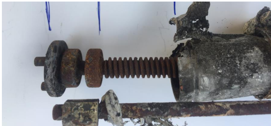
Foto 24: particolare dell'attuatore flap.
