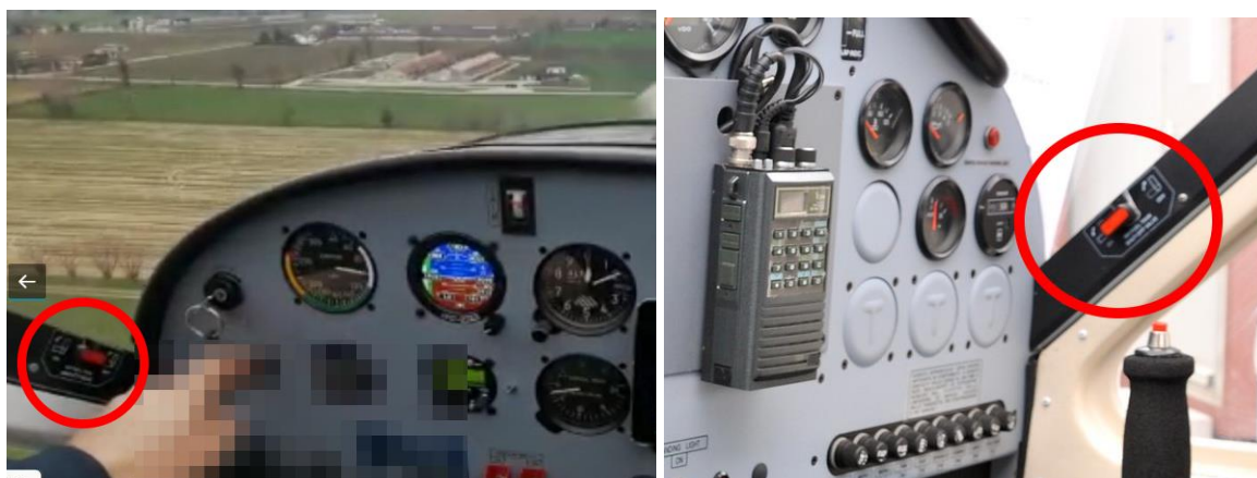
Foto 1 e 2: valvole carburante fuel shut off del serbatoio sinistro e destro (aeromobile di modello analogo a quello coinvolto nell'incidente).
