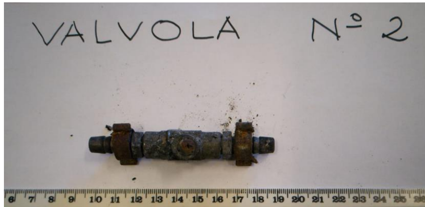
Foto 25 e 26: le due valvole fuel shut off .
