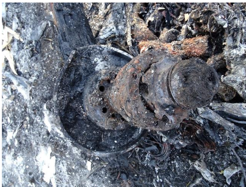
Foto 16: particolare del mozzo dell'elica separatosi all'altezza del riduttore dei giri.
