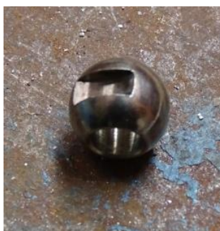
Foto 5: dettaglio della sfera interna della valvola fuel shut off .
