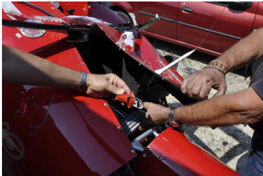
Foto 9 (a sinistra): giunto flessibile albero trasmissione moto al rotore di coda.
