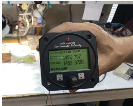
Foto 23: Statomaster Velocity, giri massimi registrati per motore e rotore.
