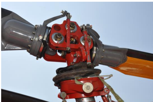
Foto 7: testa rotore principale e biellette comando passo.
