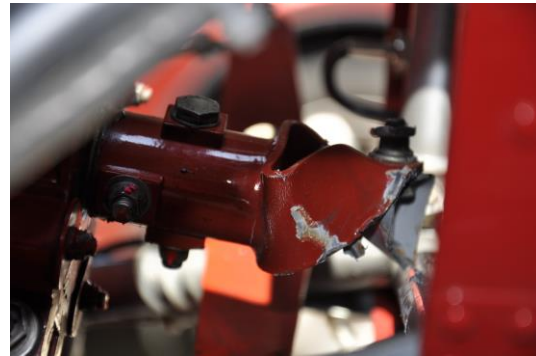
Foto 9 (a sinistra): giunto flessibile albero trasmissione moto al rotore di coda.
