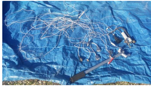
Foto 18: leva collettivo e cablaggi relativi al governor .
