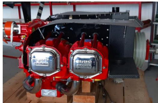
Foto 4: paratie motore in fibra di carbonio.
