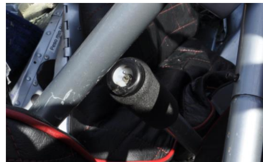
Foto 14: Particolare comando governor.
