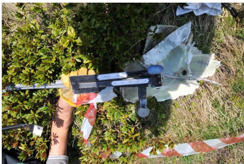
Foto 9: leva di azionamento flap e airbrake .
