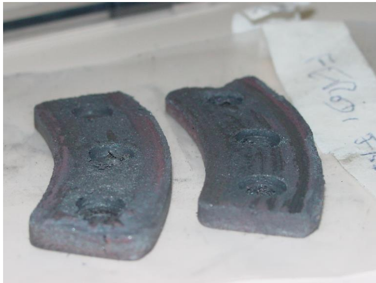
Foto 3: particolare elementi frenanti pinza freno ruota sinistra.
