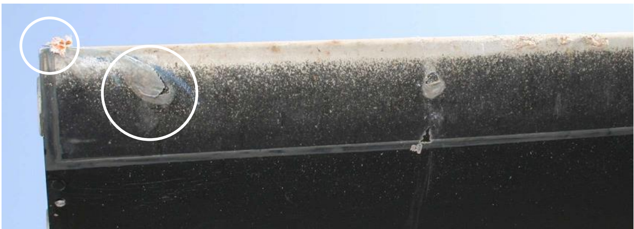
Foto 2: danneggiamento pala rotore principale (nel cerchio piccolo, materiale stabilizzatore verticale sinistro; nel cerchio grande, segni di colore blu).
