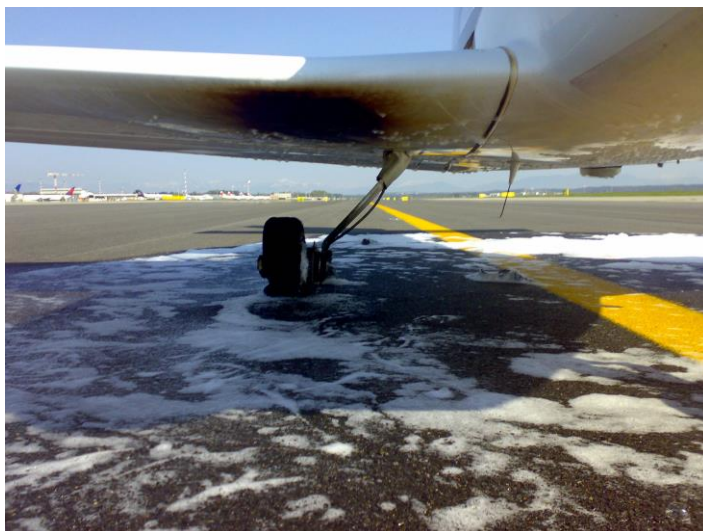
Foto 1: danneggiamenti a seguito dell'incendio.
