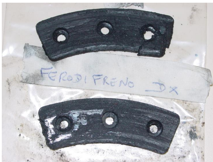
Foto 2: particolare elementi frenanti pinza freno ruota destra.
