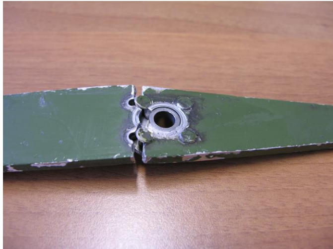
Foto 3: particolare dei rivetti di fissaggio.
