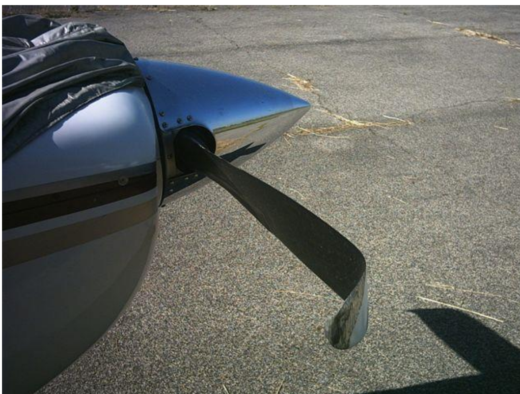
Foto 2: i danni riportati dall'elica.
