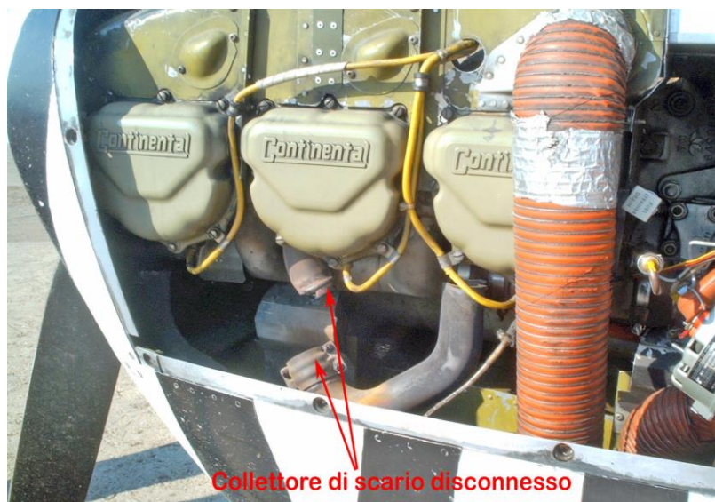
Foto 2: collettore di scarico disconnesso.
