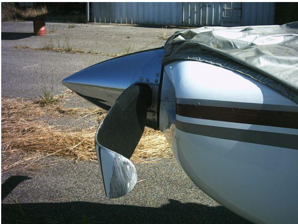
Foto 1: i danni riportati dall'elica.
