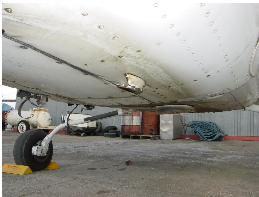
Foto 2: danni presenti sul ventre dell'aeromobile.
