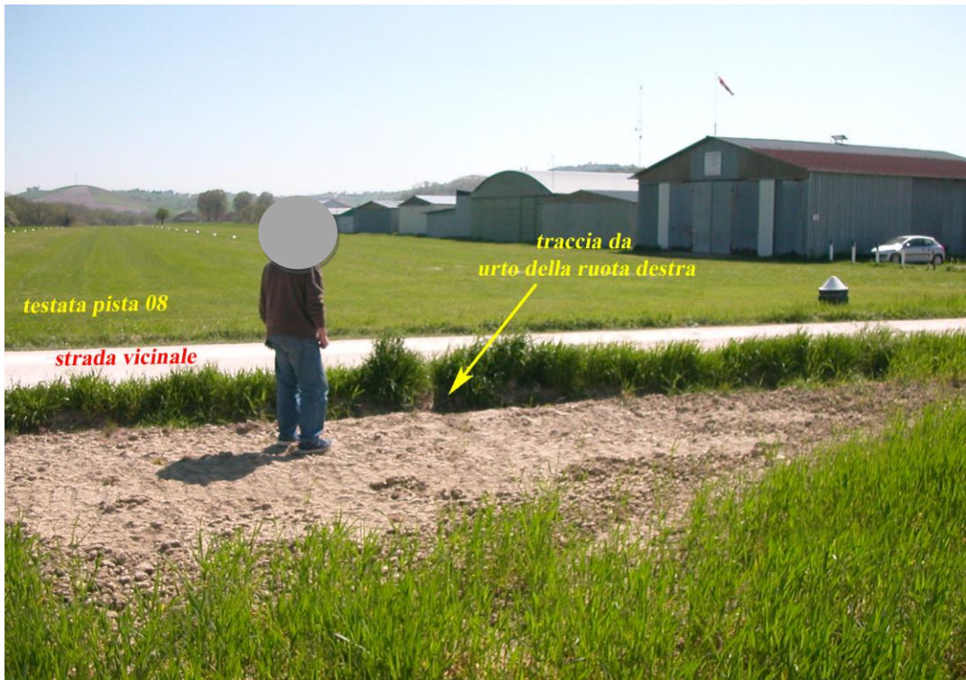
Foto 3: punto di impatto della ruota del carrello principale destro.
