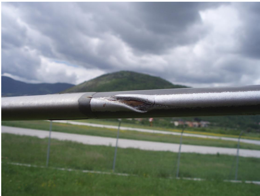
Foto 2: danni riportati da una delle pale del rotore principale.
