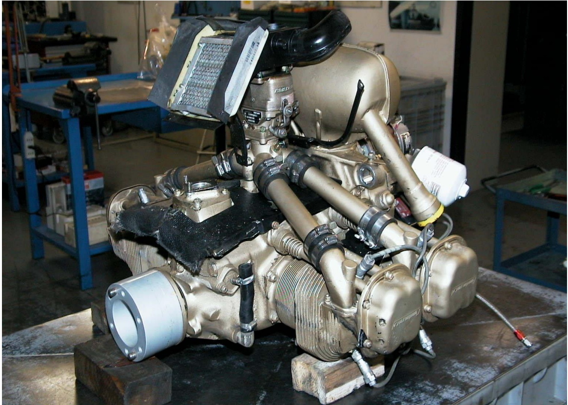
Foto 7: motore dopo la rimozione dal relitto.
