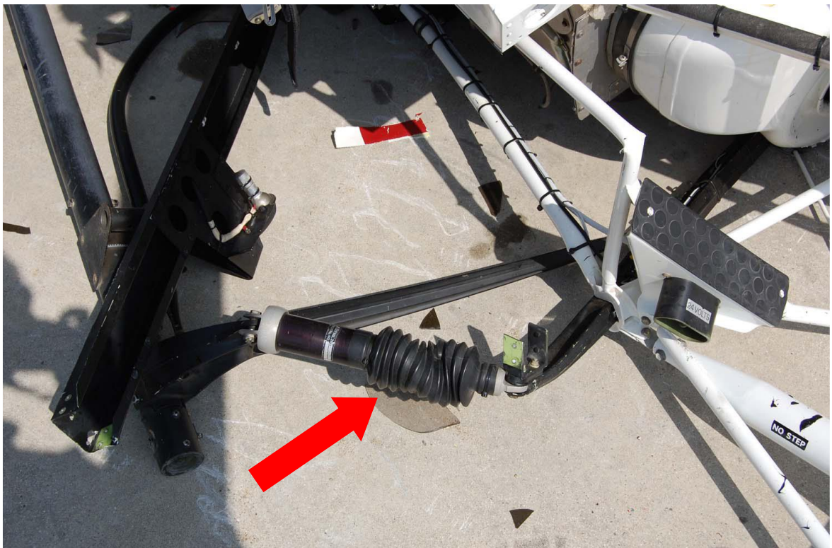
Foto 4: damper posteriore pattino sinistro.
