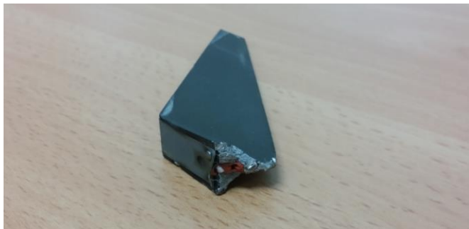
Foto 3: " L alpha vane ", aletta staccatasi dopo l'impatto.
