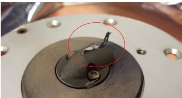
Foto 2: " L alpha vane ", trasmettitore AOA.
