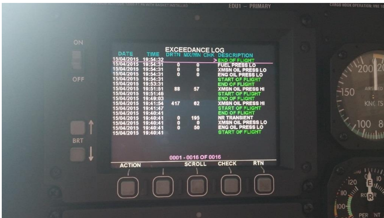
Foto 1: dati salienti del volo registrati dall'EDU. Si possono notare gli orari di decollo e atterraggio, nonché la sosta intermedia di 3 minuti per la verifica di eventuali danni. Da notare che il sistema considera END/START OF FLIGHT la transizione del motore in ground idle . Inoltre, le indicazioni di bassa pressione olio sono assolutamente normali durante le fasi iniziali di accensione.
