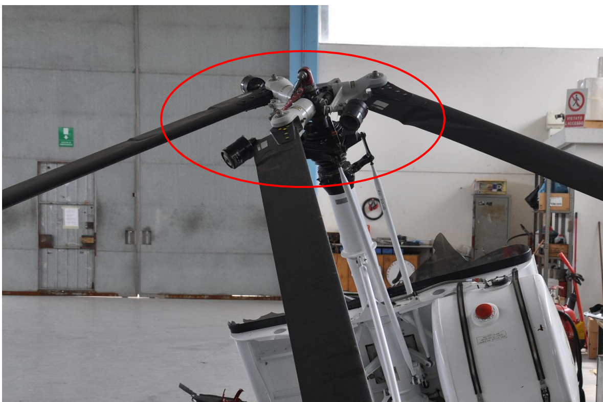
Foto 6: damper delle pale del rotore principale.
