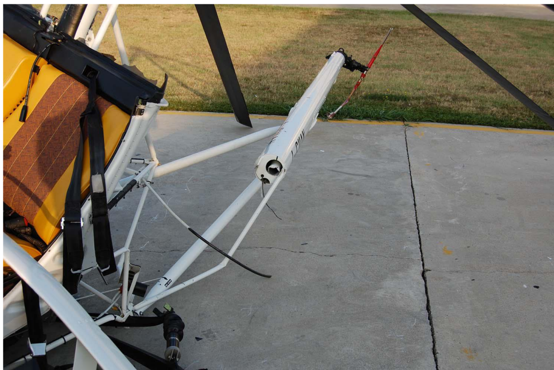
Foto 2: danneggiamento trave di coda.
