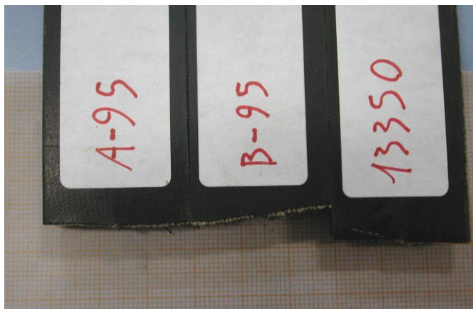
figura 21 – confronto dimensionale cinghie S/N A-95, B-95 e 13350
