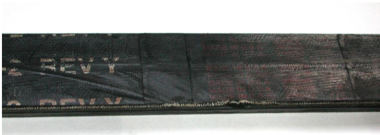
figura 7 – segni d'usura cinghia S/N 13350
