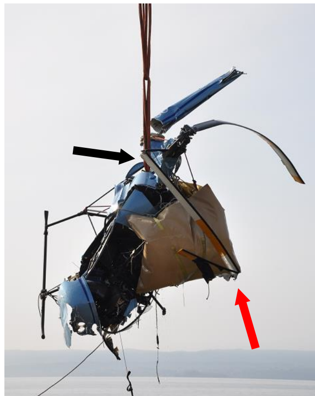
Foto 11: rotture riscontrate a carico della pala S/N 6363.
