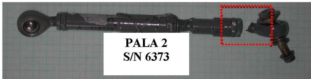
Figura 2 – Asta comando passo della pala RP s/n 6373
