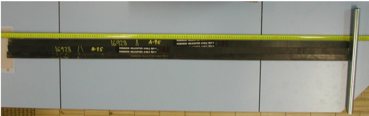
figura 20 – misure dimensionali cinghie S/N A-95, B-95 e 13350
