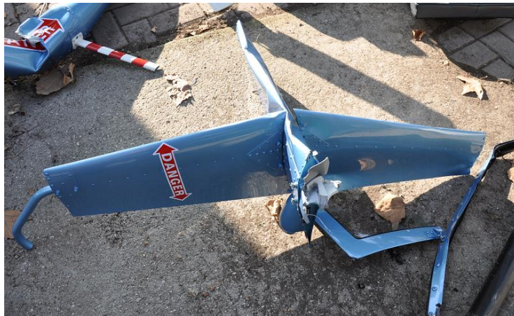
Foto 6: frammento contenente gli impennaggi di coda.
