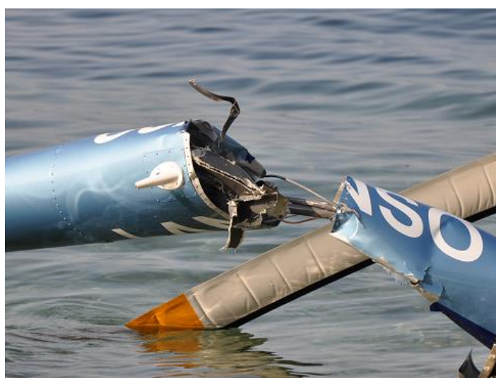
Foto 4: dettaglio della rottura circolare della trave di coda.
