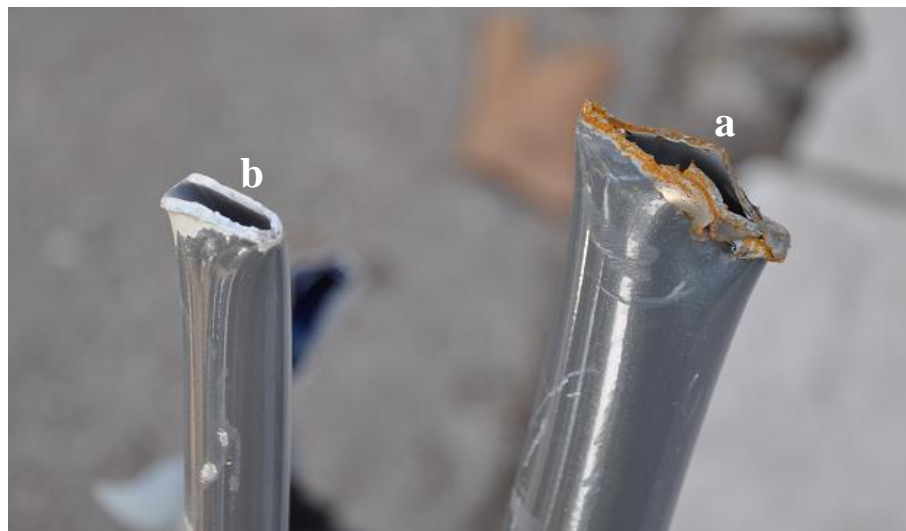
Foto 8: deformazioni e rotture dell'albero di trasmissione (a) e dell'asta comando passo (b).
