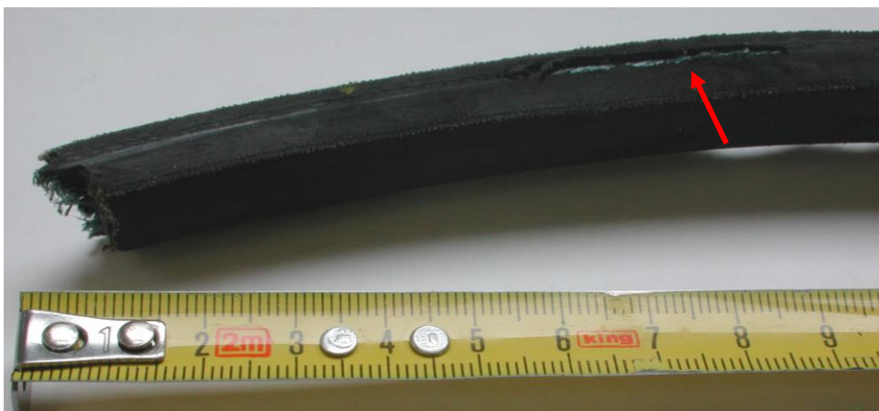
figura 14 – delaminazioni laterali spezzone A
