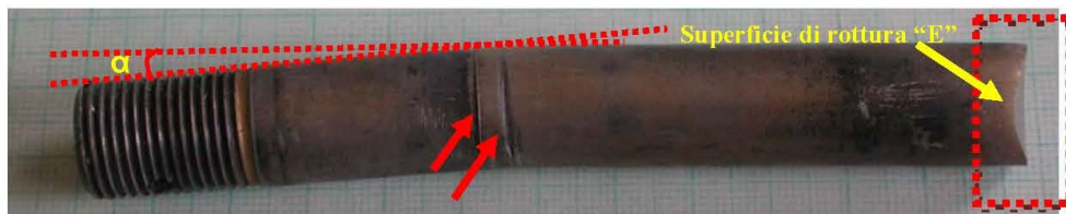
Figura 13 – Bullone di collegamento della pala RP s/n 6373
