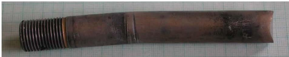
Figura 3 – Bullone di collegamento della pala RP s/n 6373
