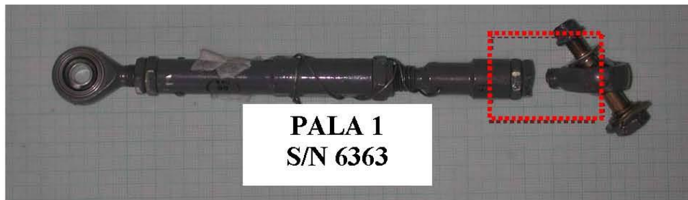
Figura 1 – Asta comando passo della pala RP s/n 6363
