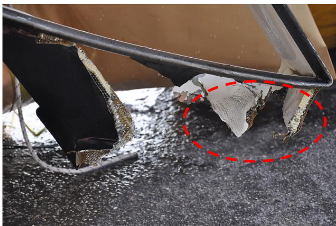
Foto 12: evidenze riscontrate sulla rottura più esterna della pala S/N 6363.
