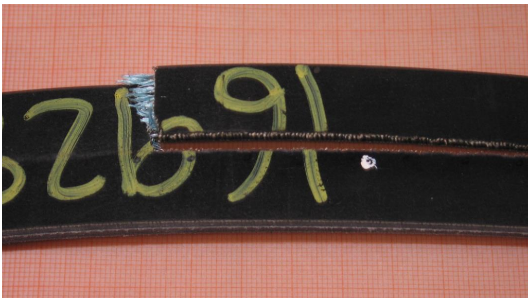
figura 24 – morfologia rottura prova di trazione
