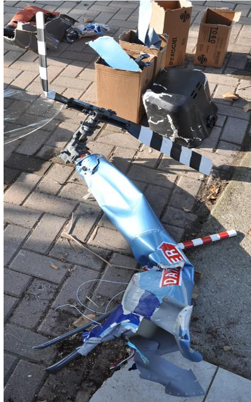
Foto 5: frammento terminale della trave di coda con rotore di coda ancora collegato.
