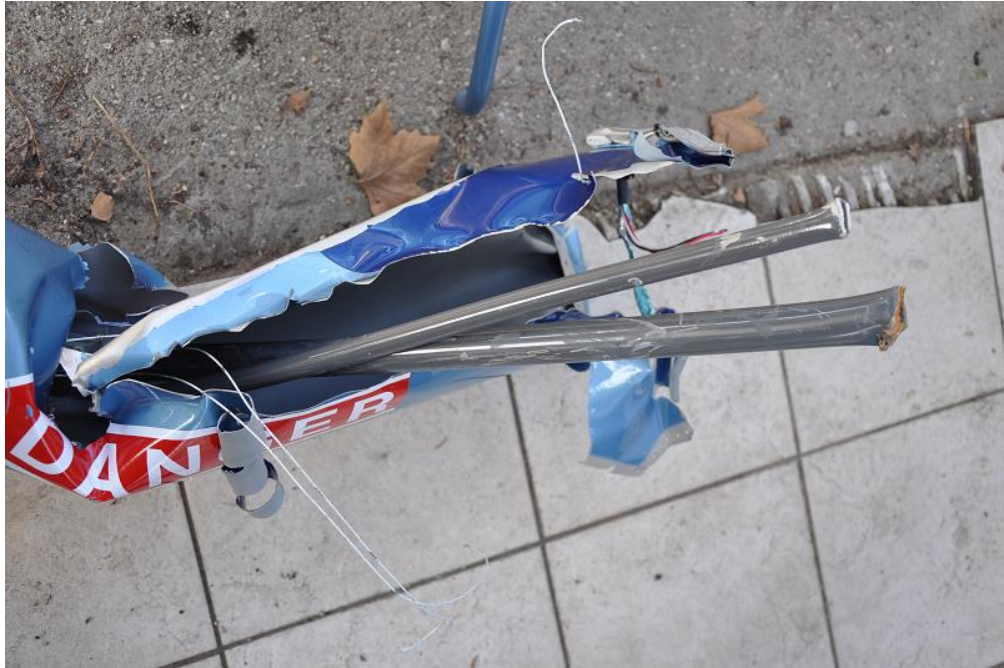
Foto 7: terminale della trave di coda; particolare delle aste ritorte.
