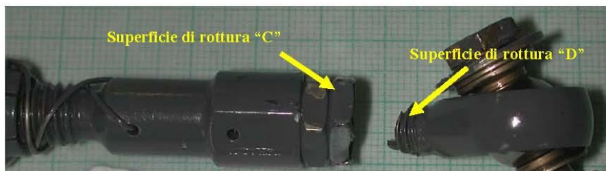
Figura 8 – dettaglio asta comando passo della pala RP s/n 6373
