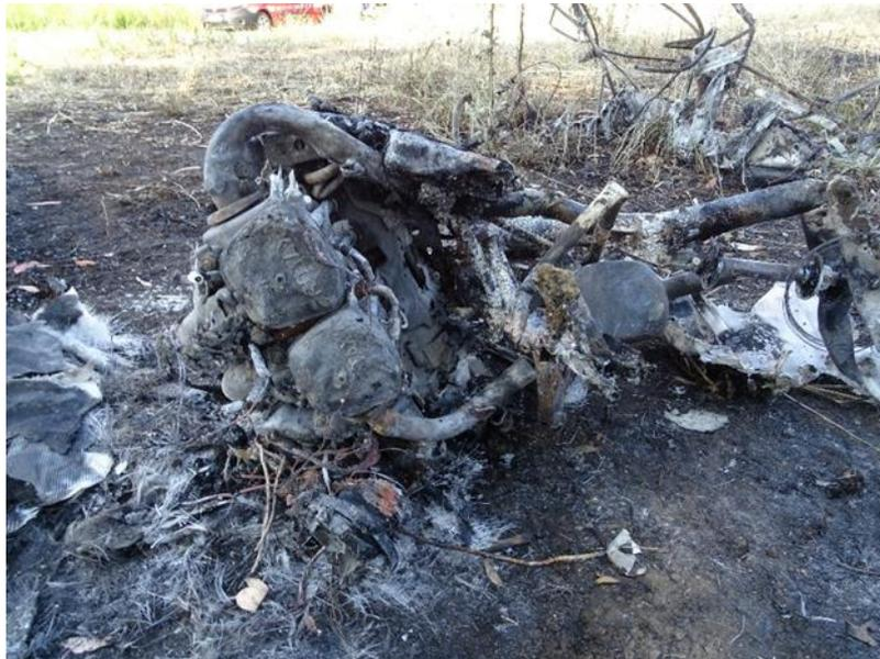
**Primo piano del motore dell'aeromobile coinvolto nell'incidente.**
