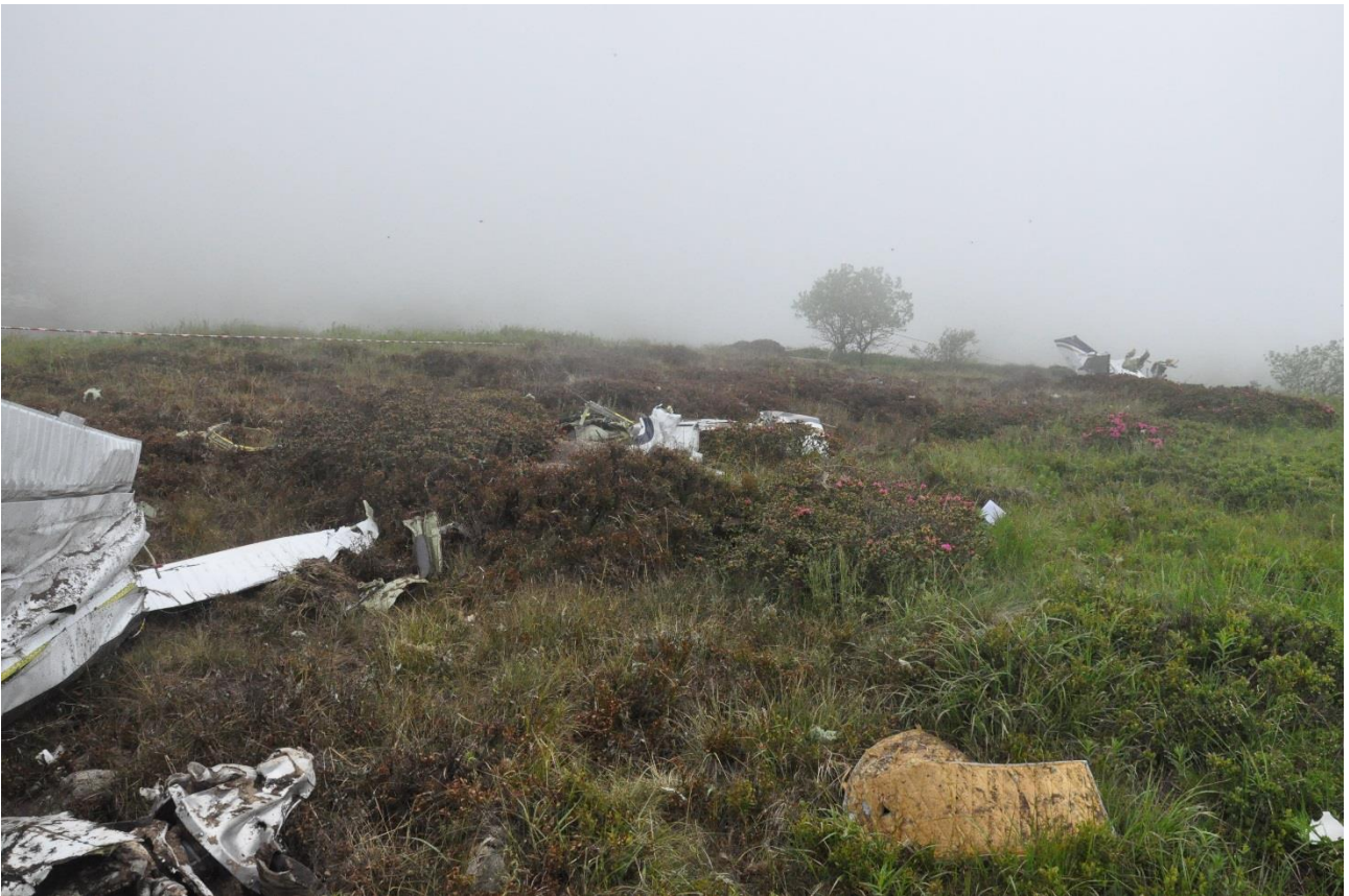
Foto 8: distribuzione dei rottami. La foto è stata effettuata il giorno seguente a quello dell'incidente.
