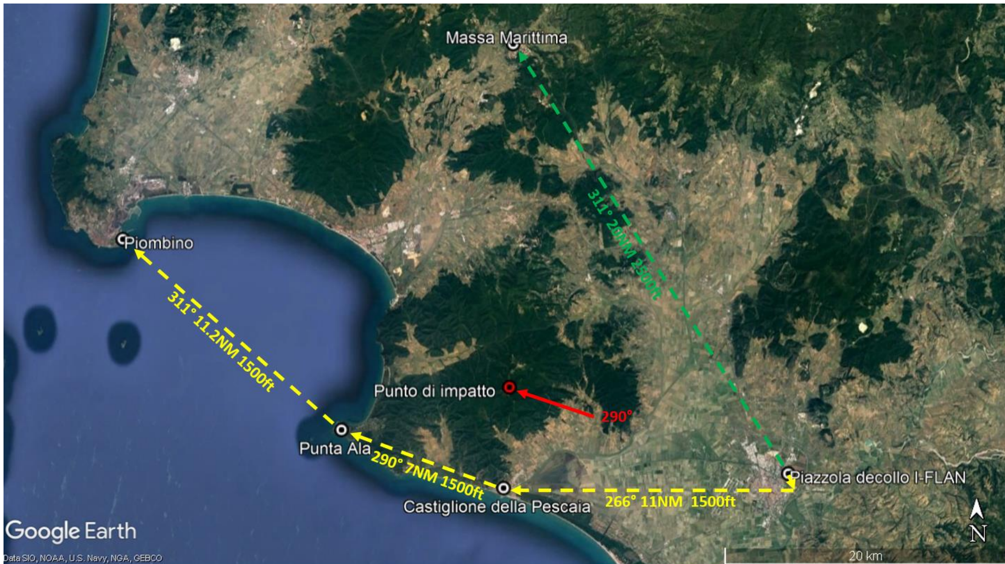
Foto 15: rotte previste dal Manuale dell'operatore da Grosseto a Pisa, direzione e punto di impatto I-FLAN (su supporto Google Earth).
