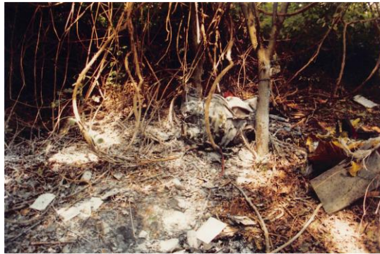
Foto 13: motore sinistro e tracce di incendio post-impatto.
