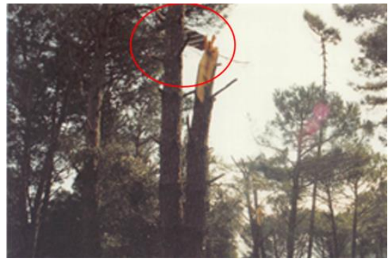
Foto 4 e 5: a sinistra, alberi tranciati precedenti il punto di impatto; a destra, sezione di pala rotore principale conficcata nel tronco.
