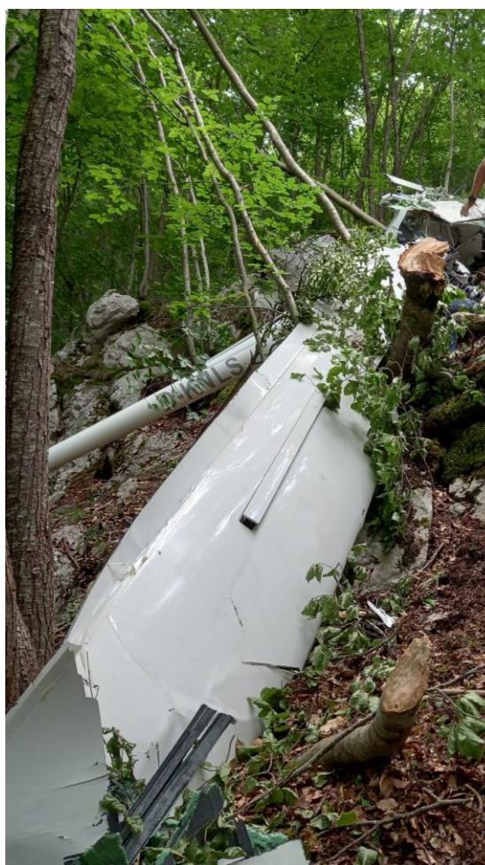
Foto 4: segni di interferenza tra arbusti e semiali del D-KVLS.
