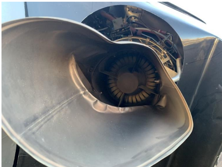
Foto 6: ultimo stadio turbina.
