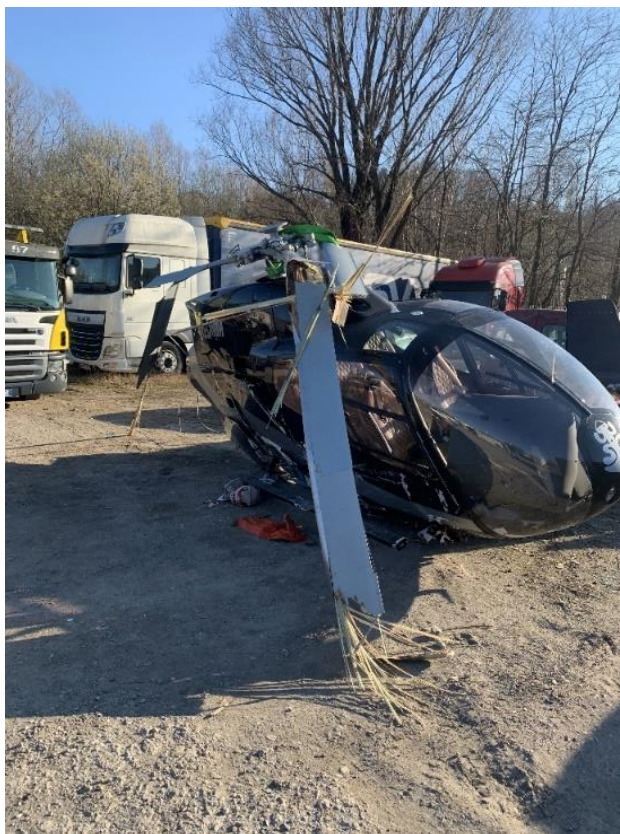
Foto 4: danni al rotore principale.
