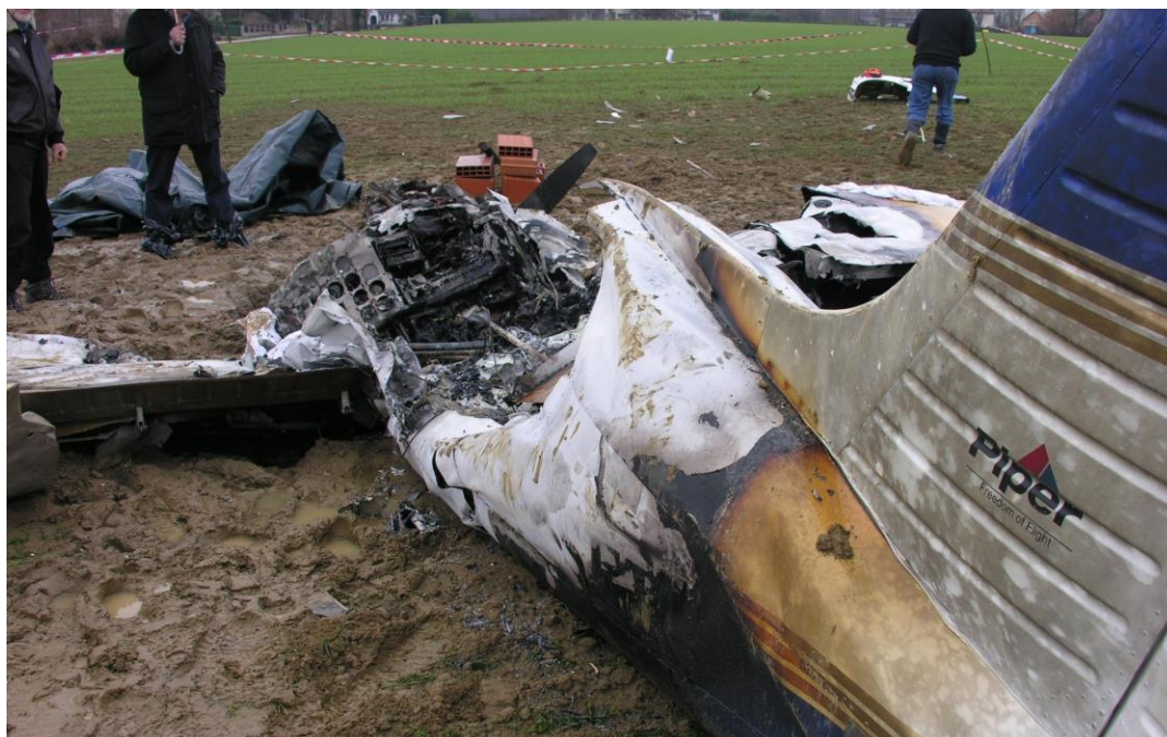
Foto 1: il relitto del PA-28-181 marche I-ESER. Si notino gli estesi danni arrecati dall'incendio sviluppatosi dopo l'incidente.
