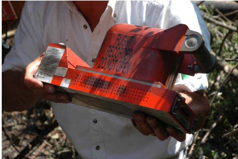
Foto 3: il CVR recuperato dal relitto dell'elicottero S-64F "Skycrane" marche I-SEAD.
