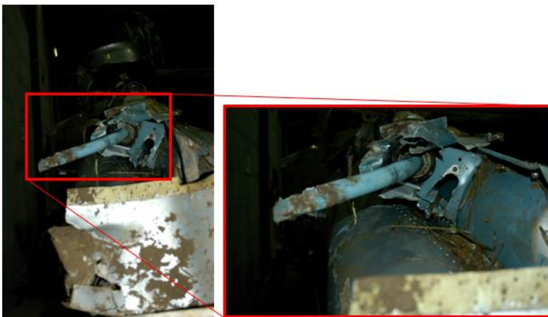
Foto 19: particolare della rottura da impatto dell'albero di trasmissione al rotore di coda.
