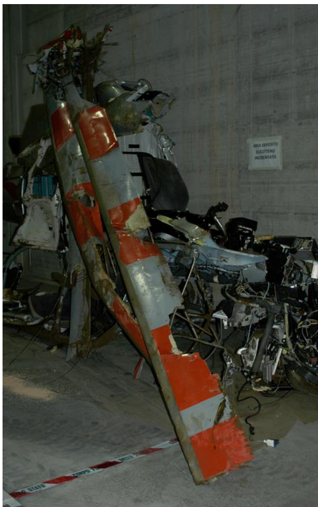
Foto 18: particolare dei danneggiamenti alle pale del rotore principale.
