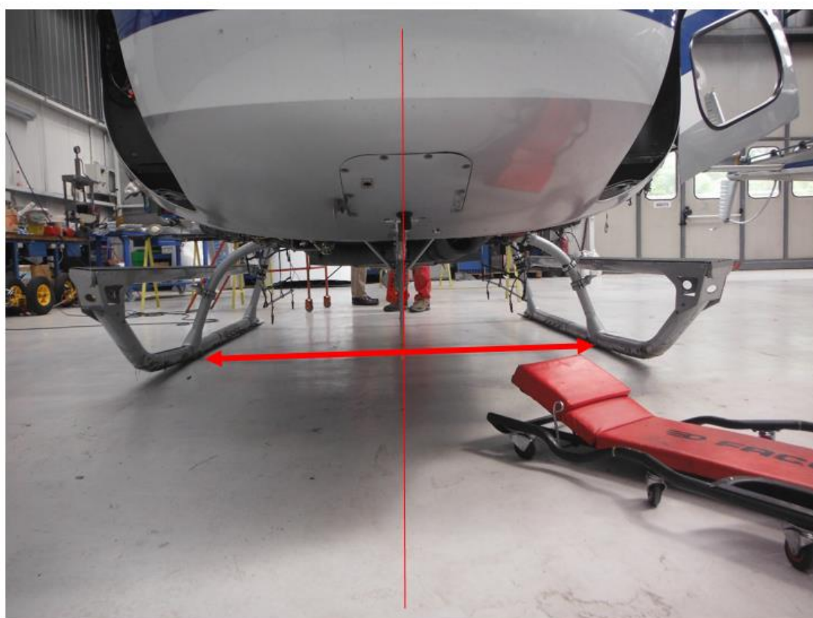
Foto 2: particolare dello svergolamento dei pattini dovuto all'urto con il terreno.
