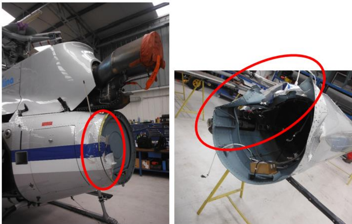
Foto 1: particolare dei danni al cono di giunzione tra la carlinga ed il trave di coda.
