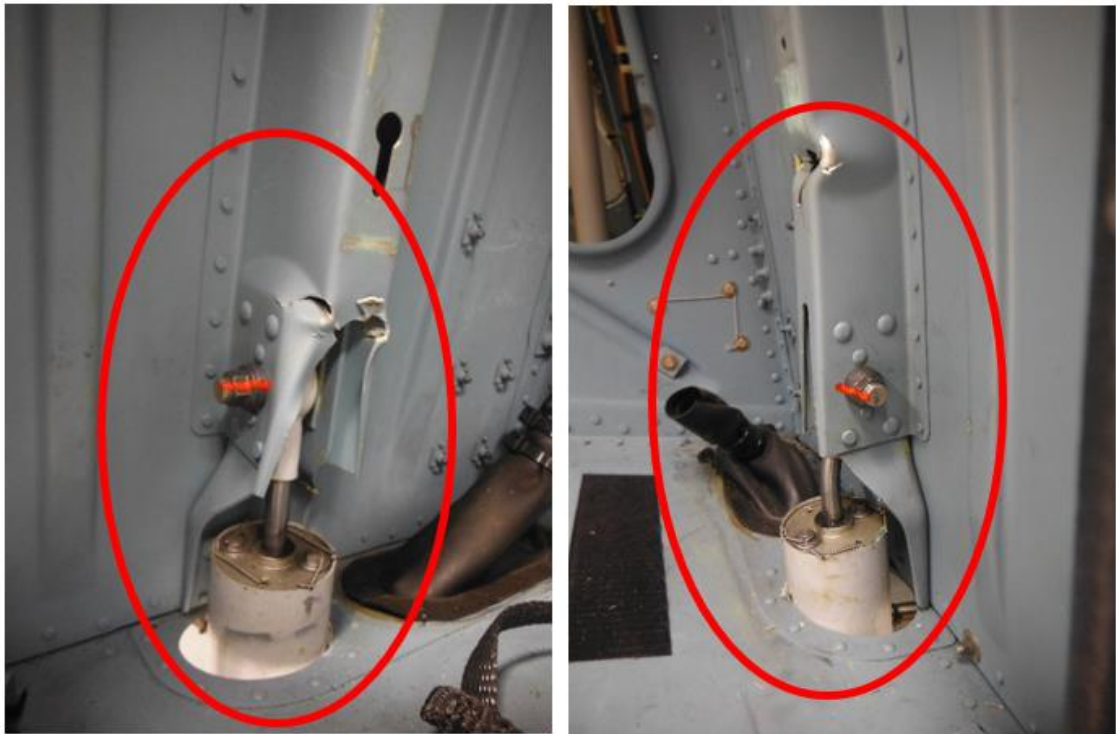
Foto 3: particolare dei danni subiti dagli shock absorber dell'elicottero.
