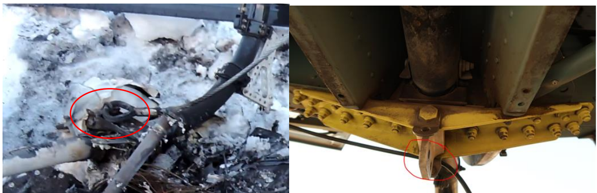
Figura 4: punto di vincolo ipotizzato per il posizionamento del carico esterno. In alto schema di gancio baricentrico. A sinistra foto scattata subito dopo l'incidente, a destra immagine del punto di vincolo su elicottero similare all'I-LGLG.
