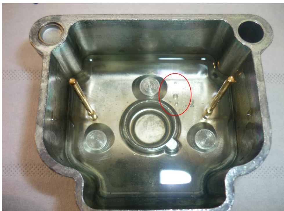
Foto 5: vaschetta del carburatore dei cilindri n°1-3. Evidenziate dall'ovale rosso le gocce di acqua.
