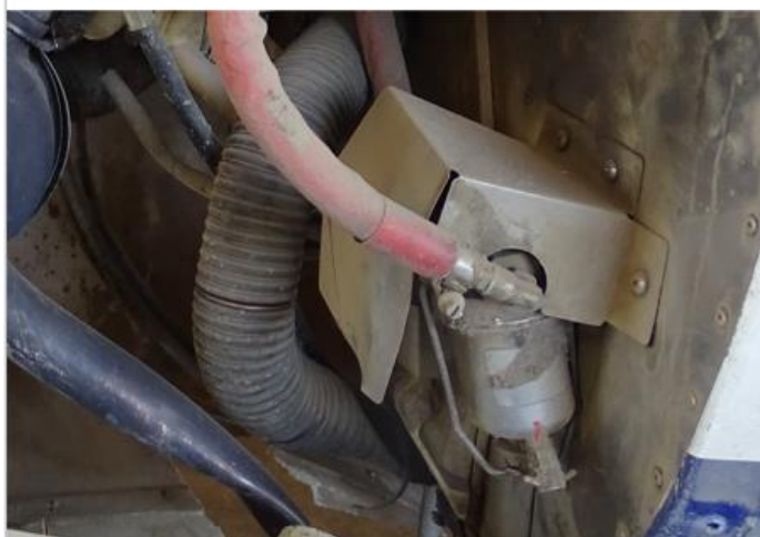
Foto 6, 7, 8, 9: presenza di residui di terriccio all'interno del gascolator (foto 6) a seguito del contatto con il terreno che ha provocato la rottura della cofanatura motore (foto 7) con contatto diretto del rubinetto del gascolator con le zolle di terra, che, tra l'altro, ne ha causato la deformazione (foto 8 e 9).
