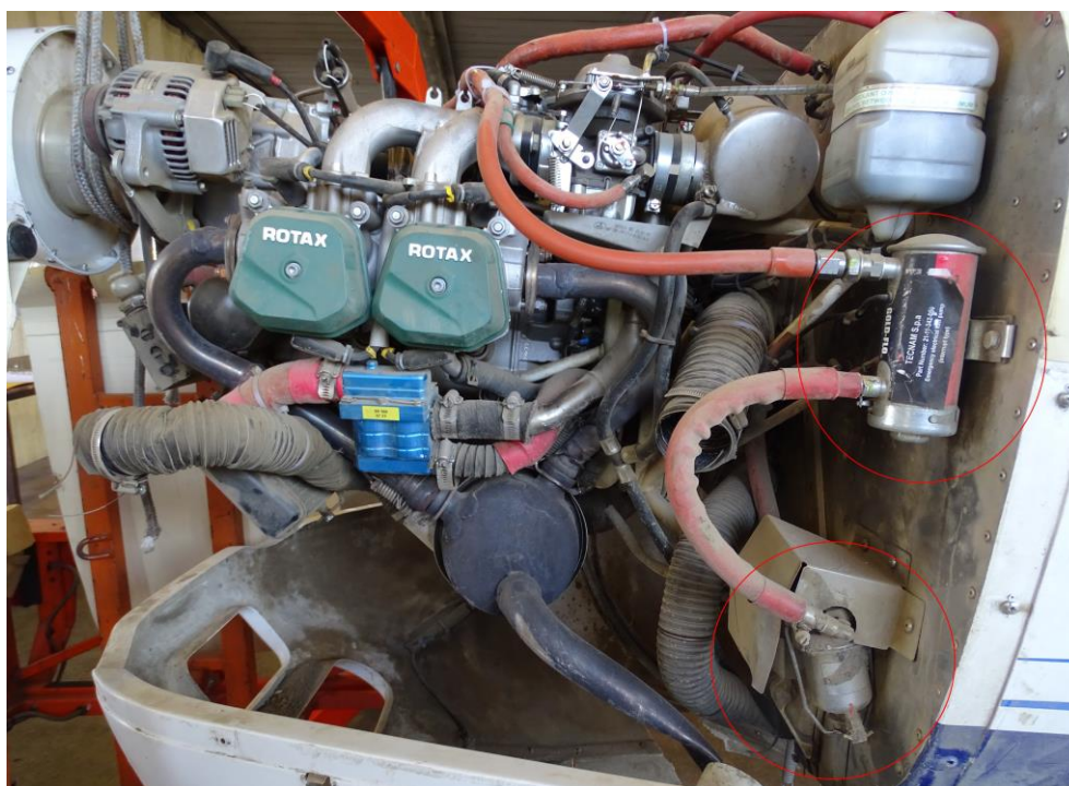
Foto 4: vista di dettaglio del motore Rotax 912 in officina dopo l'incidente prima dello sbarco per successiva ispezione. In primo piano in alto a destra la pompa elettrica ed in basso il gascolator.
