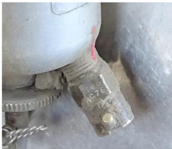
Foto 6, 7, 8, 9: presenza di residui di terriccio all'interno del gascolator (foto 6) a seguito del contatto con il terreno che ha provocato la rottura della cofanatura motore (foto 7) con contatto diretto del rubinetto del gascolator con le zolle di terra, che, tra l'altro, ne ha causato la deformazione (foto 8 e 9).
