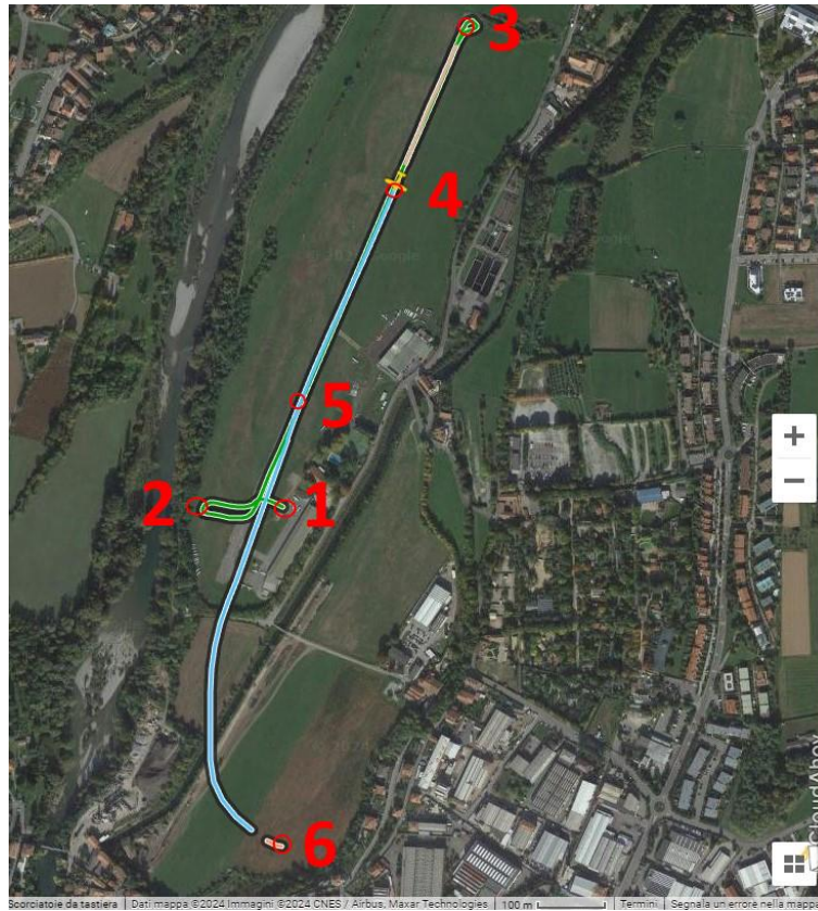
Foto 3 : 1) parcheggio e messa in moto, 2) riscaldamento, 3) allineamento dopo back track, 4) involo, 5) insorgenza irregolarità funzionamento motore, 6) atterraggio di emergenza (da applicativo Cloud Ahoy su mappa Google Earth).
