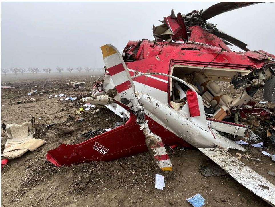
Foto 5: relitto dell'I-CPFL. Dettaglio della trave di coda.
