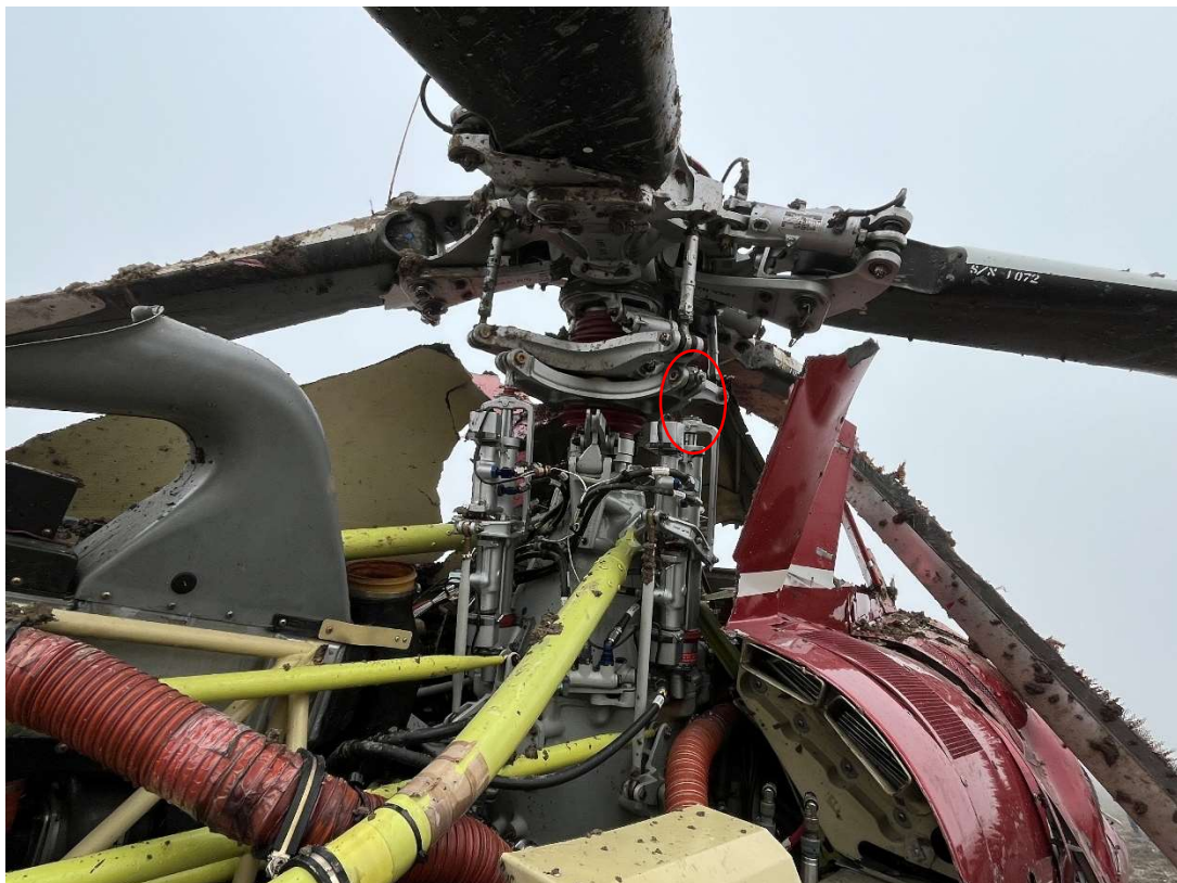
Foto 7: testa del rotore principale dell'I-CPFL. Evidenziata nell'ovale la rottura di uno dei main rotor actuators .
