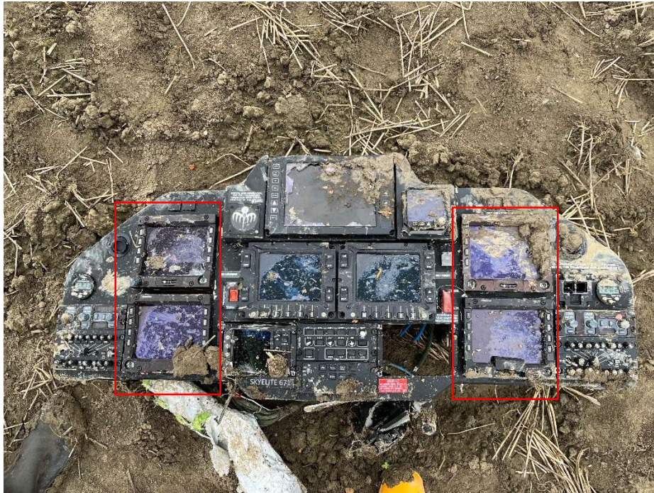
Foto 11: pannello strumenti dell'I-CPFL. Nei riquadri le 4 IDU sottoposte ad estrazione dati.
