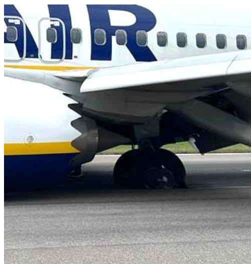
Danneggiamento alle ruote del carrello principale del B737 marche EI-IGI.
