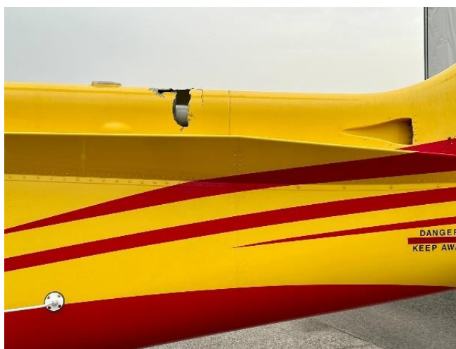
Danneggiamento dell'AW139 marche I-RJAH sulla cappottatura di protezione dell'albero del rotore di coda.
