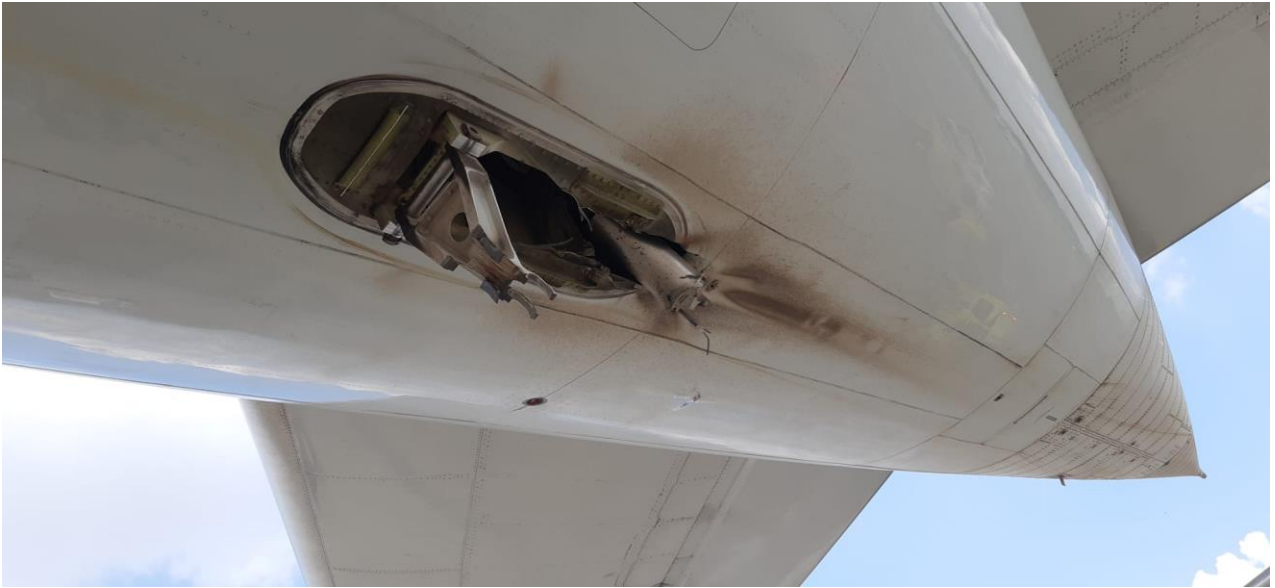
Il Boeing B777 marche di registrazione PT-MUG, particolare tail skid.
