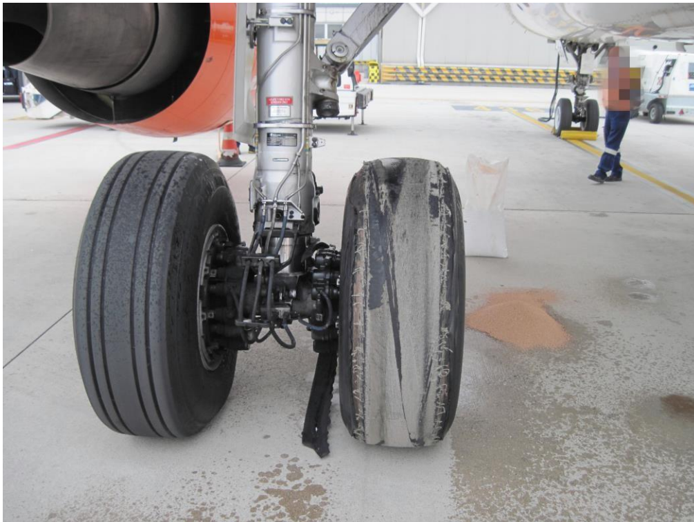
Foto 2: condizioni dello pneumatico dopo l'atterraggio dell'aeromobile a Venezia
