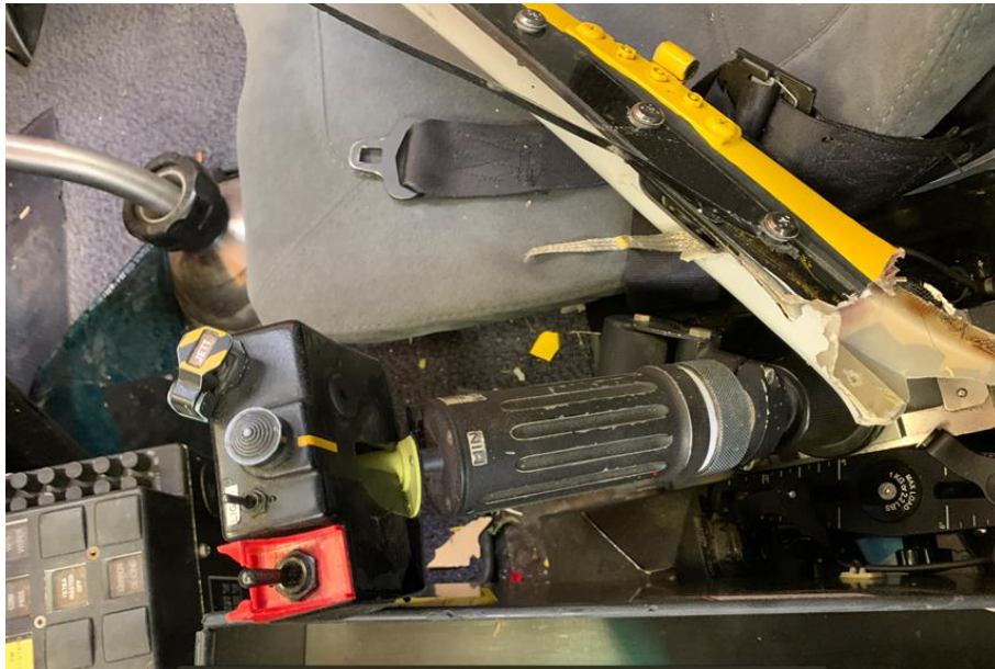
Foto 29: posizione della manopola twist-grip dopo l'incidente su “ MIN ” ( idle ).
