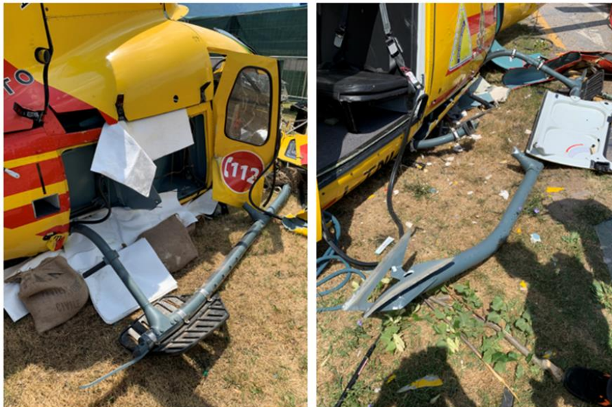
Foto 8, 9: particolari delle deformazioni sui pattini di atterraggio.
