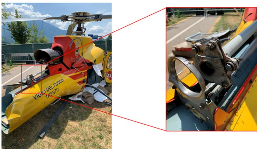
Foto 11: particolare del trave di coda e della rottura dell'albero di trasmissione del moto al rotore di coda.
