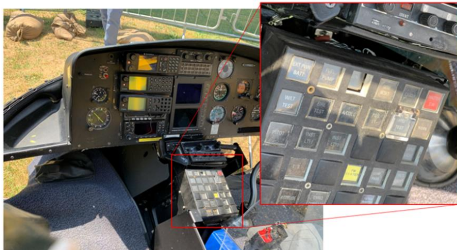
Foto 23: piantana centrale e del comando della fuel pump .
