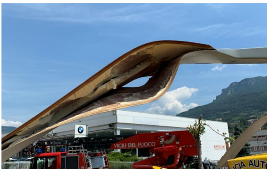
Foto 10: particolari delle deformazioni da impatto sulla pala (blu) del rotore principale.
