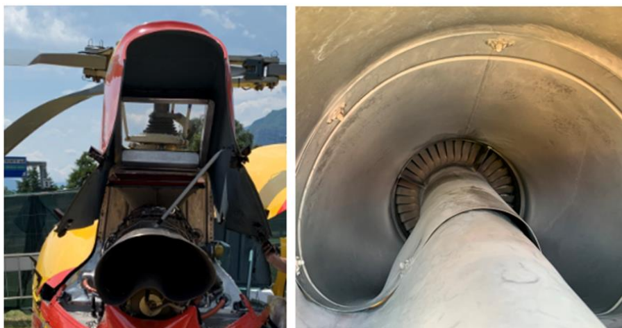
Foto 14 e 15: particolari dello stadio rotorico della turbina accessibile attraverso il cono di scarico.
