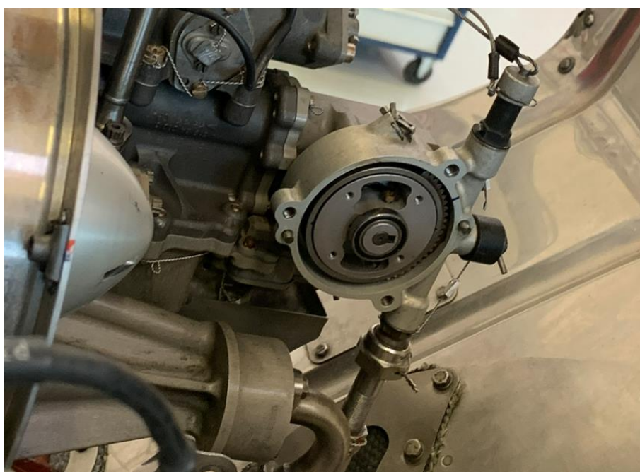
Foto 34: posizione del regolatore carburante dell’HMU, corrispondente a “Max” o emergenza.
