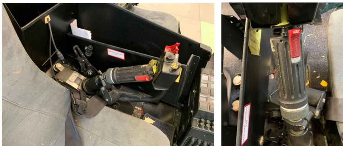
Foto 32, 33: spostamento della manopola “Twist grip” dalla posizione “vol” a “max”.
