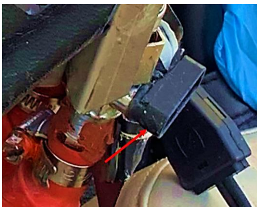
Foto 17: dislocazione di materiale plastico sulla leva comando shut-off sinistra.
