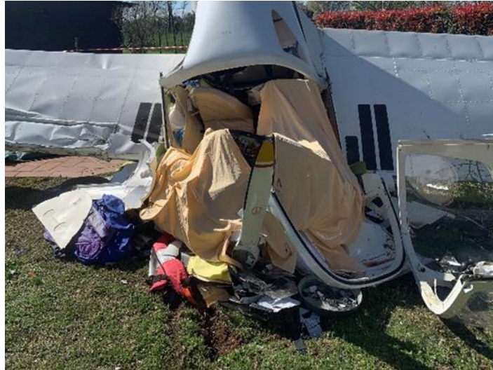
Foto 9: sezione anteriore con pala solidale al mozzo.
