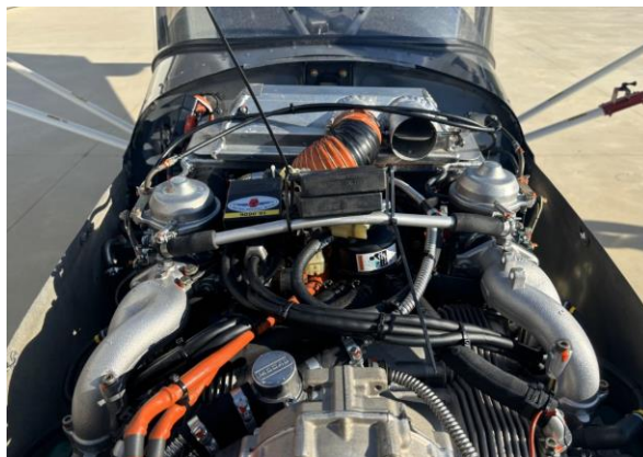
Foto 20: test centraline di accensione su altro motore Rotax 912ULS.
