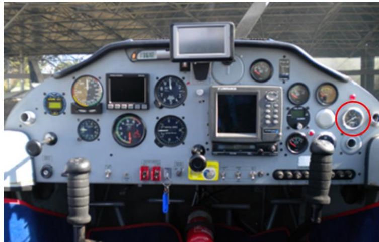
Foto 7: posizione dello strumento pressione carburante su P-96.
