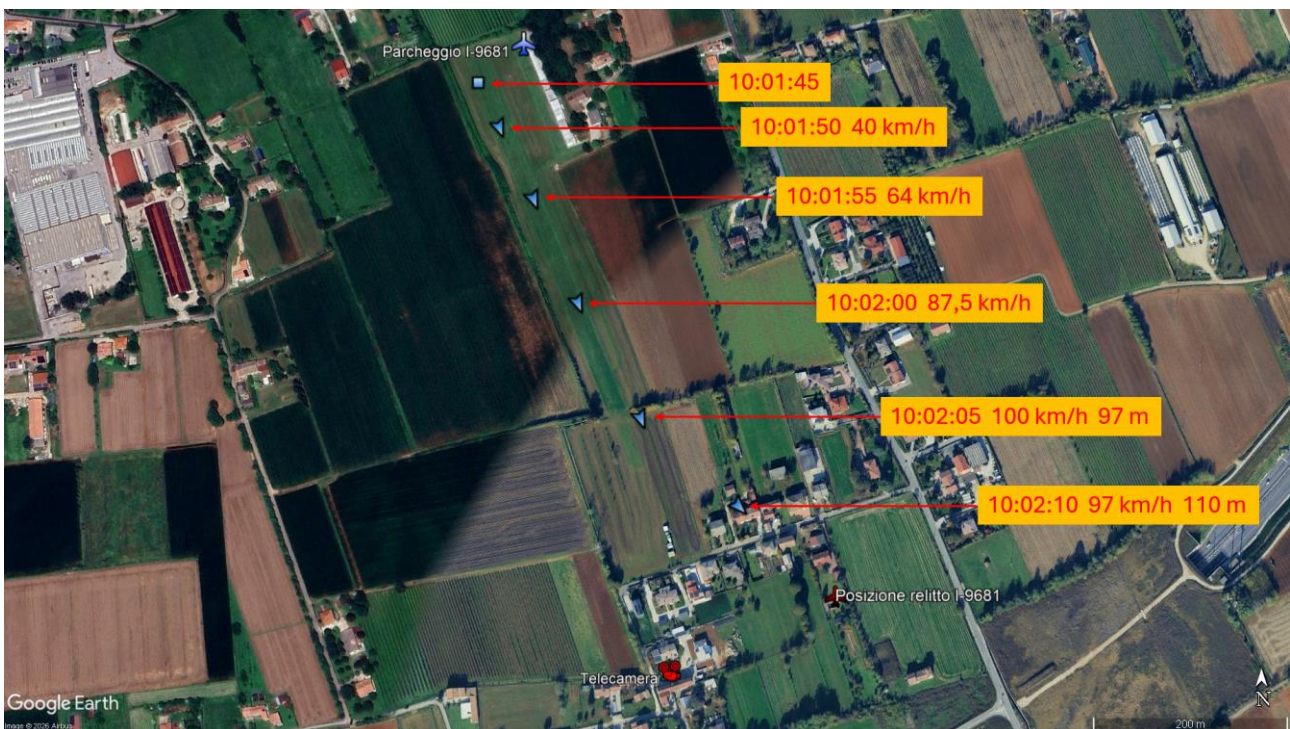
Figura 14: tracciato di volo con parametri associati ai punti registrati (dati AvMap su cartografia Google Earth).
