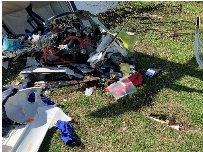
Foto 10: distruzione sezione anteriore e solco pala elica sul terreno.
