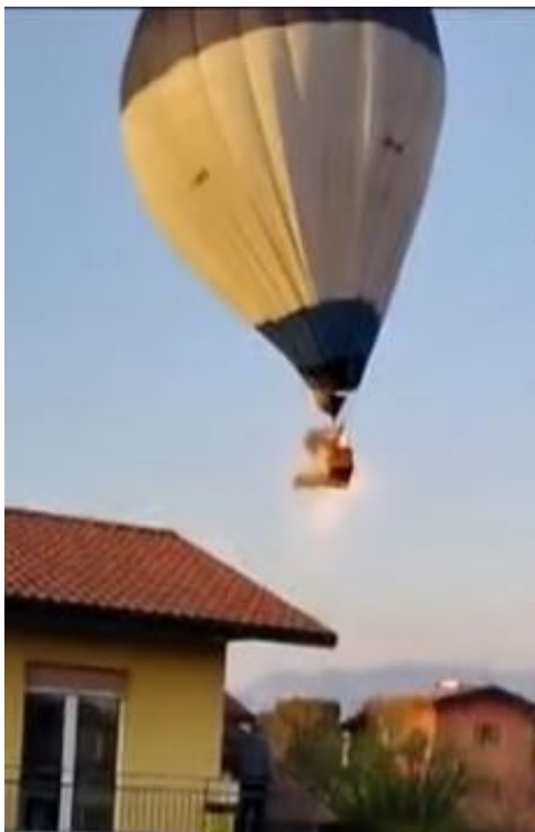
Foto 1 e 2: la mongolfiera PH-NFR dopo l'impatto con l'elettrodotto (foto a sinistra), e dopo l'atterraggio (a destra).
