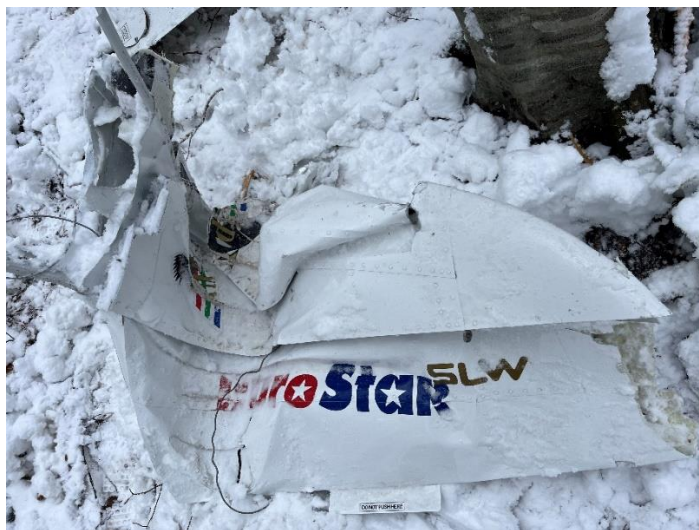
Foto 4 e 5: parti degli impennaggi dell'aeromobile I-D310.
